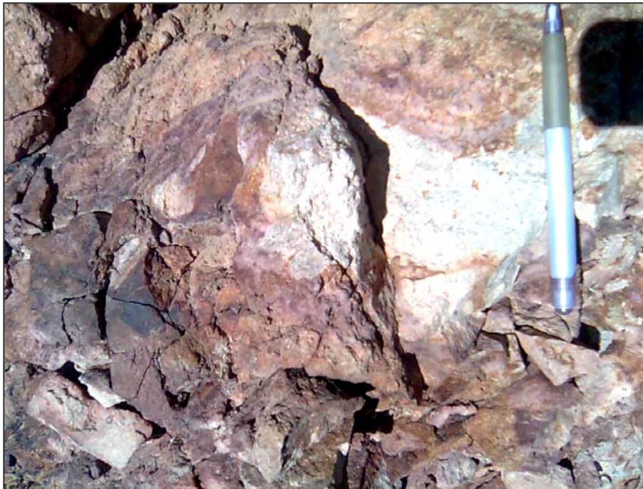
شکل (۳-۱۷): آثاری از اکسید آهن و پیریت به همراه آلتراسیون کائولینیتی
