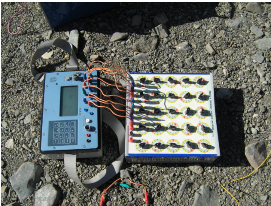
تصویر ۲-۷: گیرنده (رسیور) ELREC-10 ساخت شرکت IRIS فرانسه به همراه سویچ باکس ساخت سازمان زمین شناسی کشور (گروه ژئوفیزیک).
