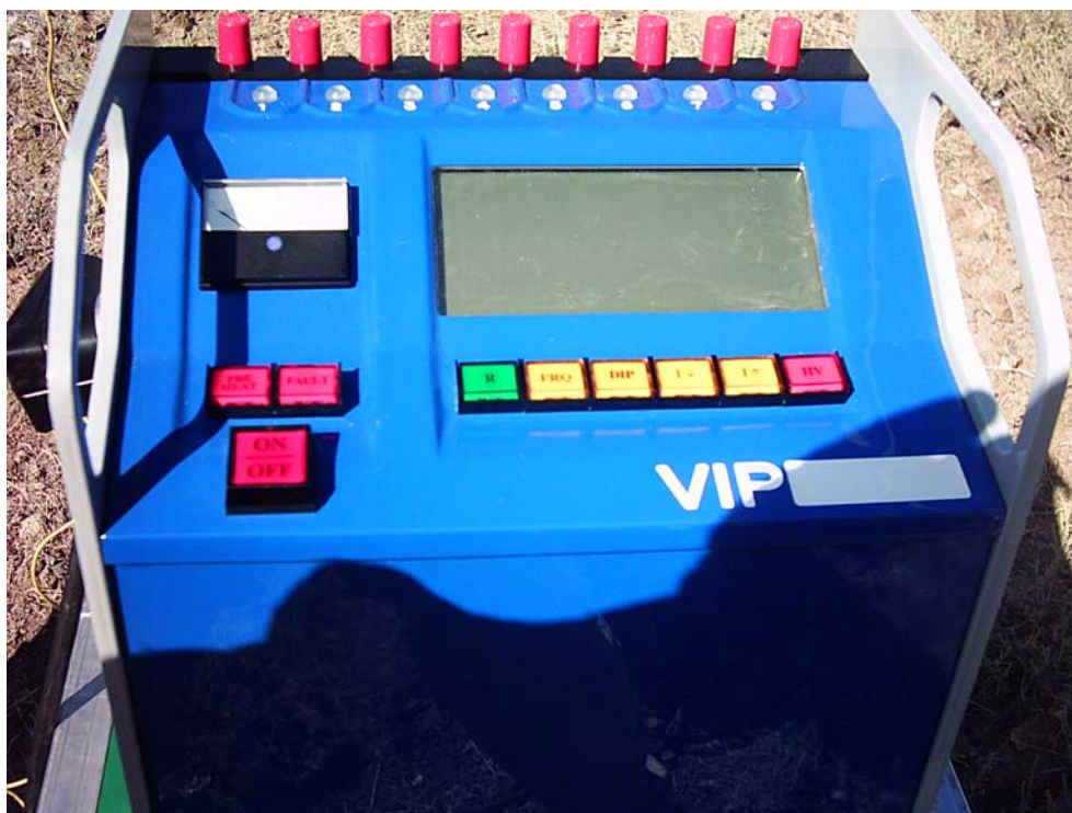
تصویر شماره ۲-۶: ترانسسمیتر VIP ساخت شرکت IRIS فرانسه
