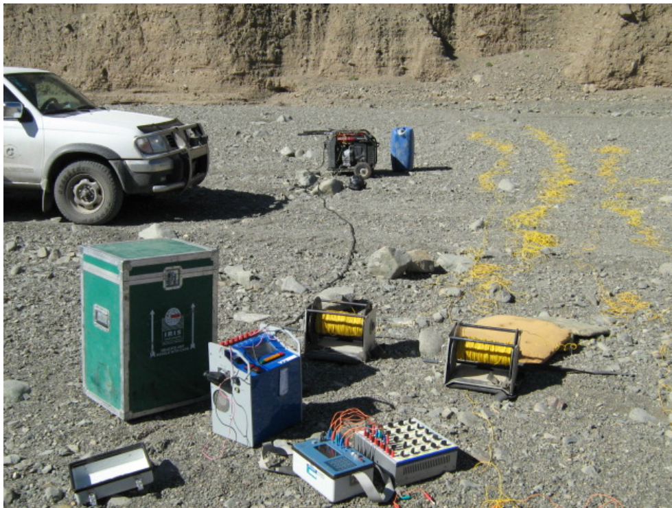
تصویر ۲-۵: مجموعه موتور ژنراتور، ترانسسمیتر و رسیور به همراه سیمهای فرستنده جریان
