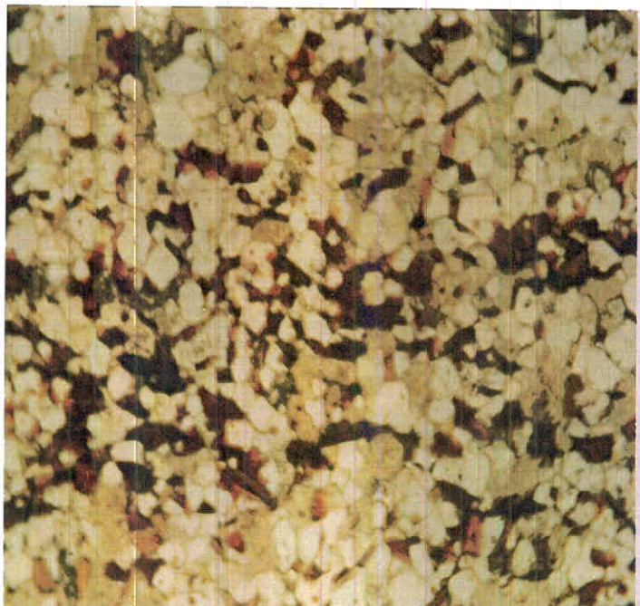
عکس شماره ۱۰۶ : مقطع نازک هورنفلس ( نورعادی ) x ۴۰
