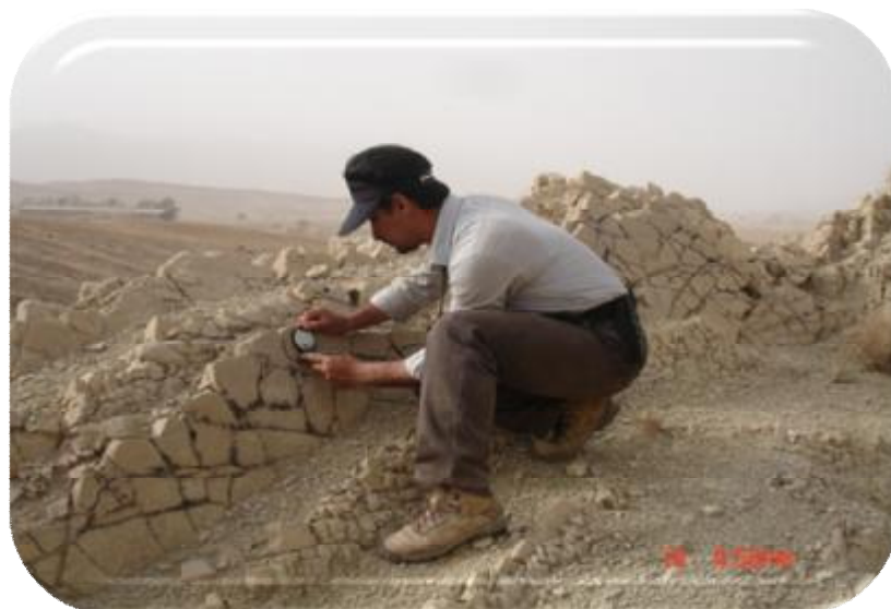
تصویر 2-3: برداشت شیب و امتداد لایه‌ها در مرحله‌ی تهیه نقشه زمین شناسی.
