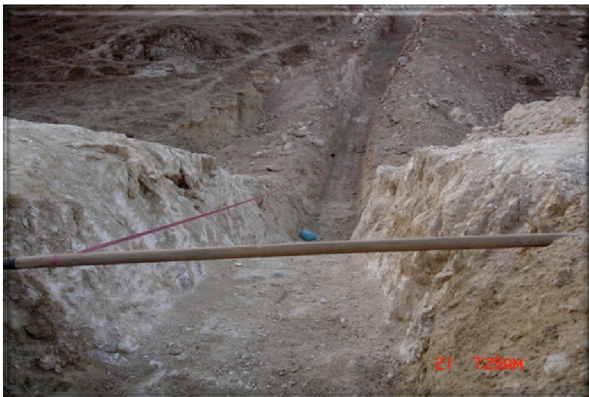
تصویر 3-5: استقرار متر جهت اندازه‌گیری مورفولوژی و همبری رخساره‌های سنگی در ترانشه‌ی اکتشافی شماره 2 (دید به سوی باختر).
