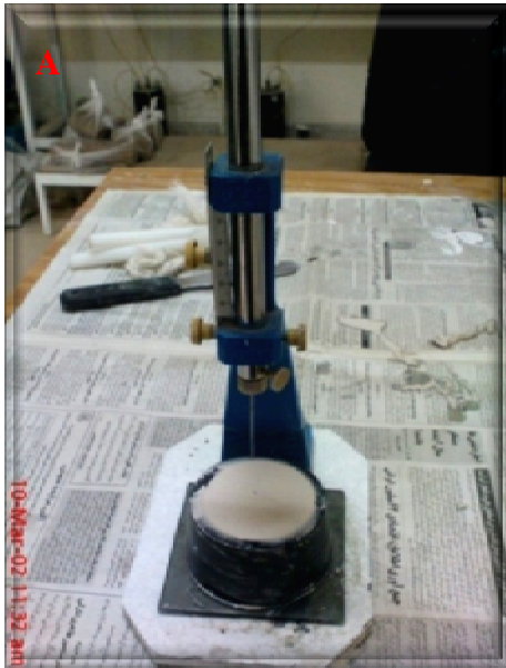
تصویر 1-5: (A) دستگاه ویکات و پُر کردن حلقه‌ی مخروطی آن از خمیر گچ. (B) نفوذ سوزن به درون خمیر جهت تعیین زمان گیرش.
