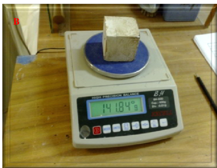
تصویر 10-1 (B & A): وزن کردن نمونه‌های خشک‌شده‌ی مکعبی شکل برای تعیین دانسیته.
