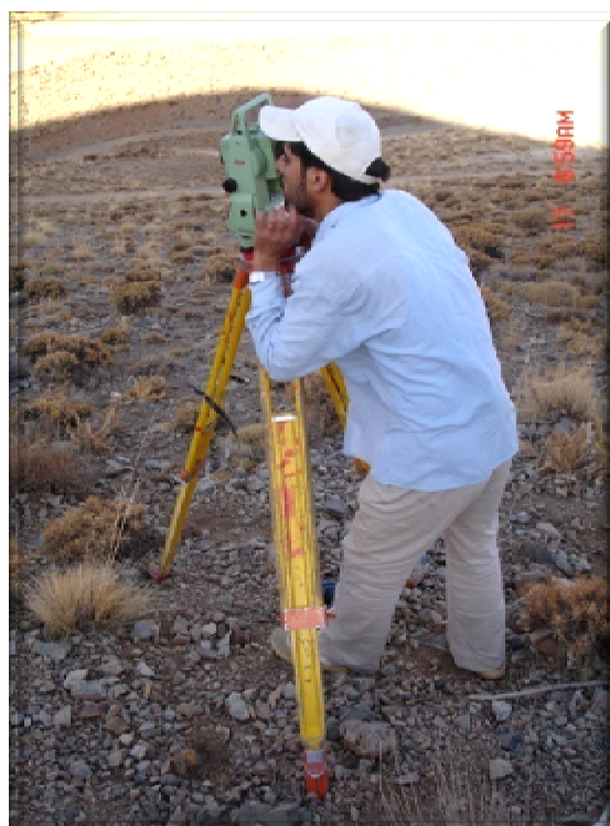
تصویر 3-1: قرائت عوارض طبیعی توسط نقشه‌بردار با دوربین توتال استیشن.
