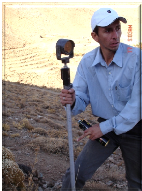
تصویر 3-1: قرائت عوارض طبیعی توسط نقشه‌بردار با دوربین توتال استیشن.
