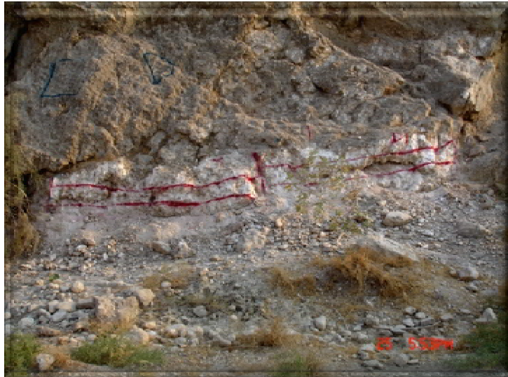
تصویر 3-4: تراش قسمت‌های هوازده‌ی لایه‌ی سنگ گچ در ترانشه‌ی طبیعی (NT1)، واقع در حاشیه‌ی رودخانه‌ی شمالی محدوده‌ی اکتشافی.
