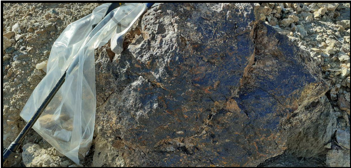
عکس ۴-۱۵۰- نمایی نزدیک از رگه لیستونیتی سیلیسی مورد نظر. نمونه BIRG2S110 همراه با اثرات اکسید آهن
