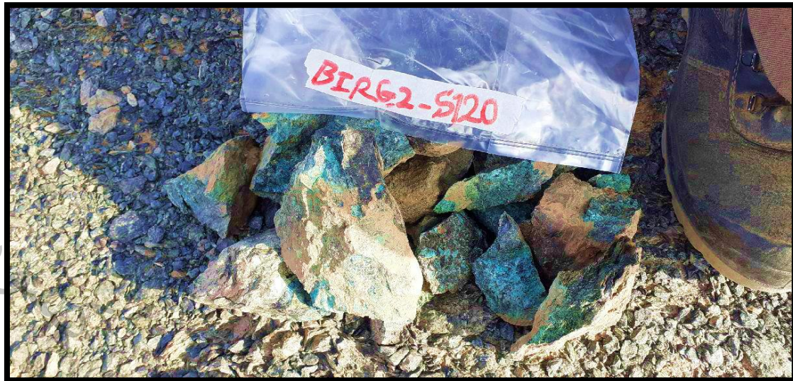
عکس ۴-۱۶۰- نمایی نزدیک از نمونه BIRG2S120. کانی‌های سبز و آبی رنگ مالاکیت و آزوریت هستند.
