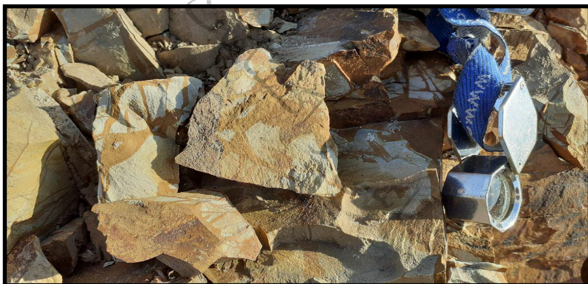
عکس ۴-۱۱۲- نمایی از حالت برشی و استوک ورکی زون آلتره در شیست‌ها که با کربنات و لیمونیت پر شده است. (نمونه BIRG2S112)
