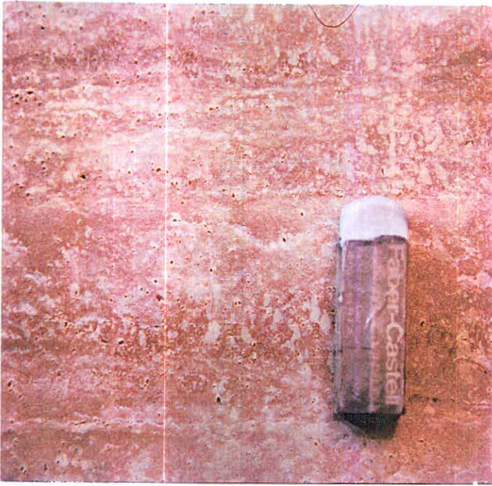
عکس شماره (۱۹) نمای پلاک ساب و صیقل خورده تراورتن کرم دینگله کهریز
