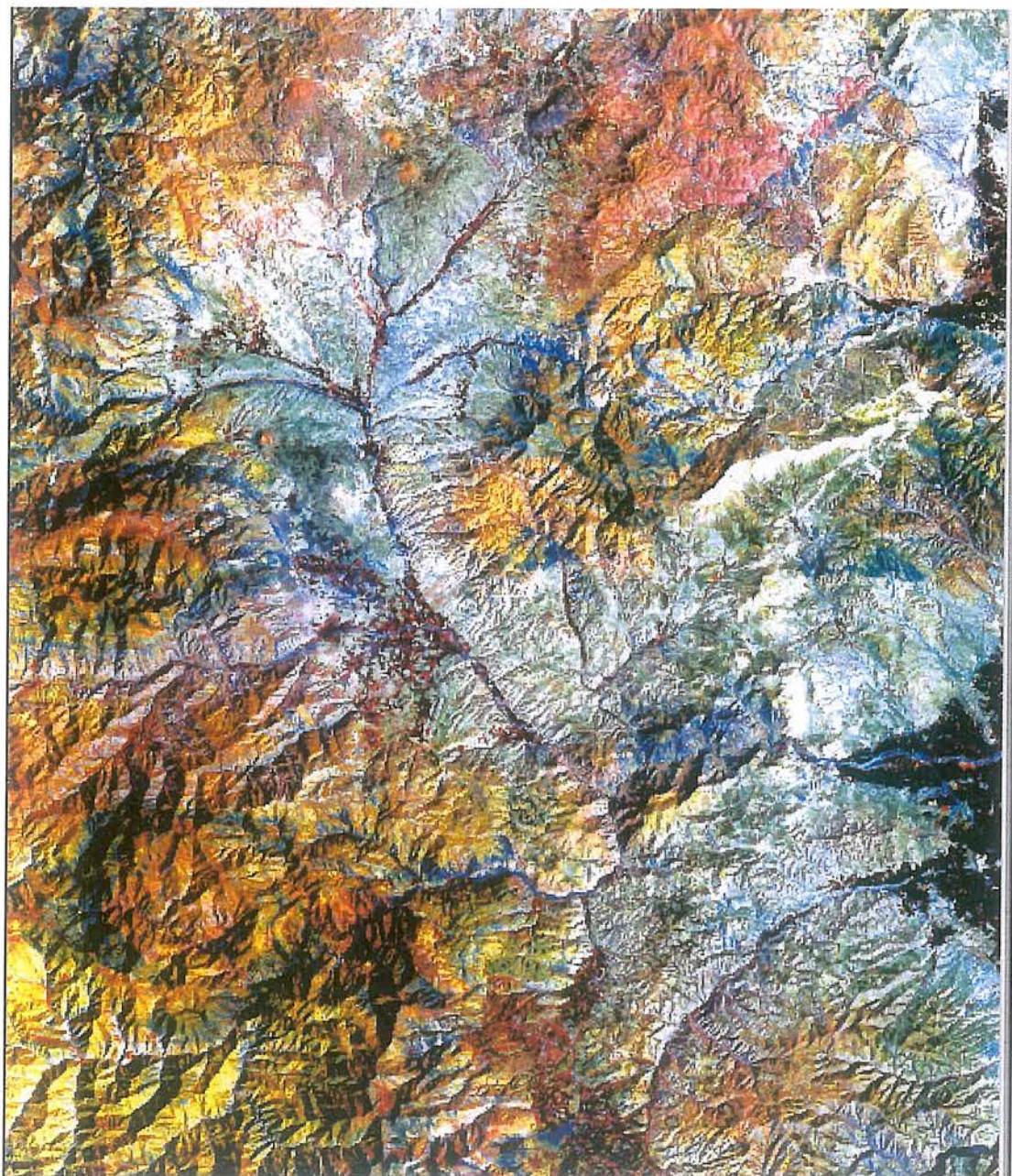
تصویر ۴- تصویر رنگی مجازی حاصل از ترکیب باندهای ۱ و ۳ و ۵ با اعمال فیلترینگ پایین گذر (LowPass)
