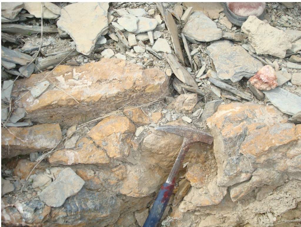
شکل شماره (۴-۲۰): تصویر محل برداشت نمونه A2-311-M، رگه سیلیسی - لیمونیتی درون سیلت کربناتی
