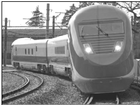
شکل ۴-۵: قطار تست با قابلیت تغییر عرض محور
