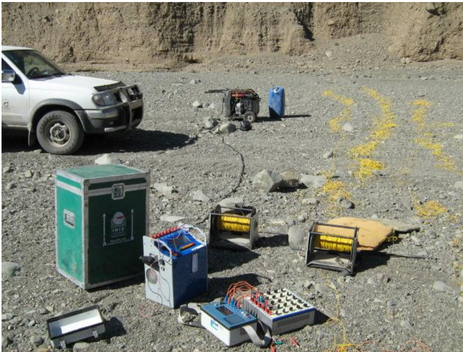
تصویر شماره ۳- مجموعه موتور ژنراتور، ترانسمیتر و رسیور به همراه سیمهای فرستنده جریان
