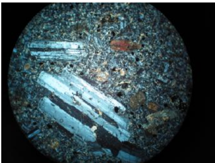
تصویر شماره 4-82: نمایی از بلورهای پلاژیوکلاز (نوع الیگوکلاز-اندزین)، بیوتیت و آمفیبول (نورپلاریزه متقاطع، 4x).
