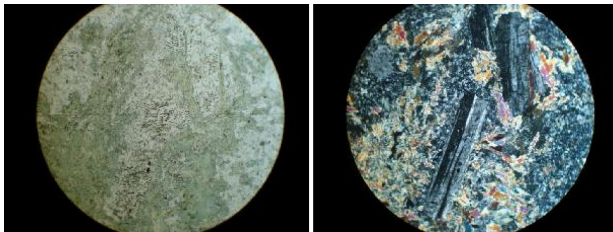
تصویر شماره 4-47: پلاژیوکلازها و کانی های فرومنیزین کاملاً کلریتی شده در زمینه کوارتز-فلدسپاتیک و کریپتوکریستالین (الف - نور پلاریزه، ب - نور طبیعی، 10x).
