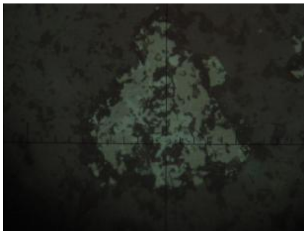
تصویر شماره 4-145 : نمایی از بلورهای مگنیتیت (خاکستری تیره) که در اثر مارتیتی شدن به هماتیت (خاکستری روشن) تبدیل شده‌اند - بزرگنمایی 20X
