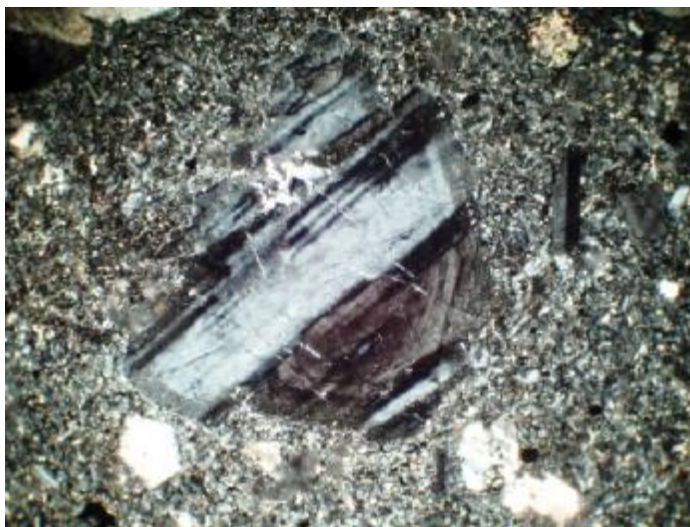
تصویر شماره 4-67: نمایی از بلور پلاژیوکلاز حدواسط (آندزین) با ماکل پلی سنتتیک با تیغه های پهن که زونینگ نیز نشان می دهد (نورپلاریزه ، 10x).
