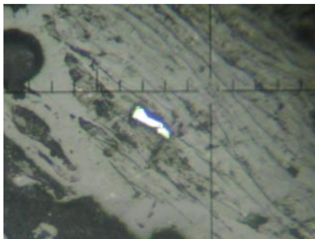
تصویر شماره 4-161: نمایی از یک ریزبلور پیریت دانه پراکنده و سالم - بزرگنمایی 10X
