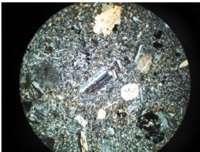
تصویر شماره 4-71: نمایی از بلورهای پلاژیوکلاز، آمفیبول و کانی های اوپک در زمینه میکروکریستالین سنگ (نورپلاریزه ، 4x).
