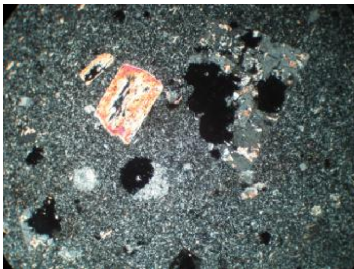
تصویر شماره 4-65: نمایی از فنوکریست‌های پلاژیوکلاز، بیوتیت و ارتوز. پلاژیوکلازها سریسیتی و ارتوزها رسی شده‌اند (نورپلاریزه متقاطع، 4x).
