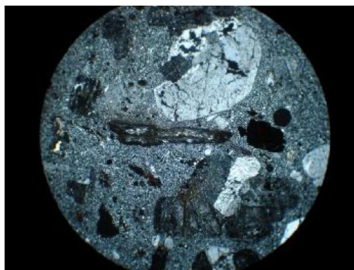
تصویر شماره 4-44: بافت عمومی سنگ شامل پلاژیوکلاز، بیوتیت، کوارتز و کانی کدر در زمینه کریپتو کریستالین (نور پلاریزه ، 4x).
