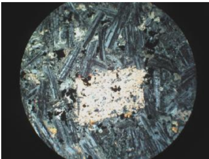
تصویر شماره 4-76: نمایی از بلورهای درشت بیوتیت و پلاژیوکلاز به همراه کانی‌های اوپک و اپیدوت (نورپلاریزه ، 4x).
