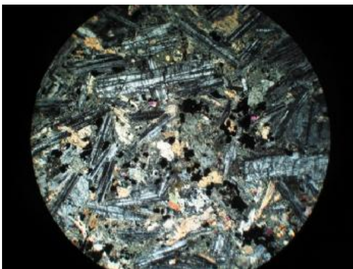
تصویر شماره 78-4: نمایی از بلورهای پلاژیوکلاز و آمفیبول به همراه کانی های اپیدوت و زوئزیت (نورپلاریزه ، 4x).
