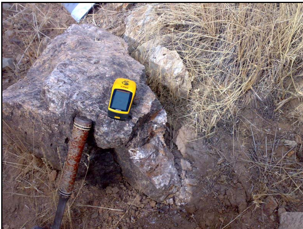
تصویر ۸: قطعه بر جای شدیداً سیلیسی - آهن دار (مینرالیزه) در محل نمونه 2-KM-61
