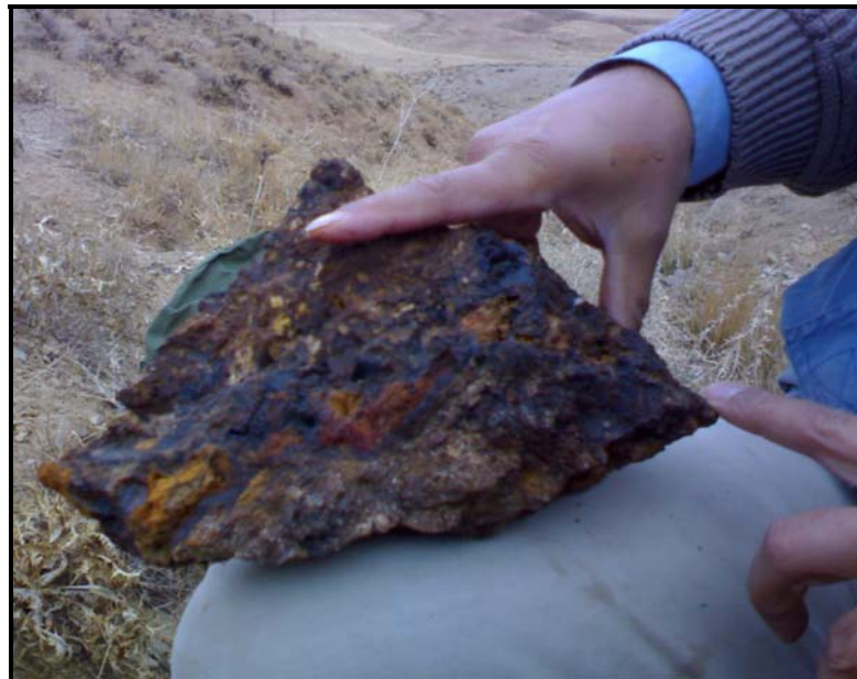
تصویر ۲۲: قطعات اکسید آهنی و منگن‌دار نمونه KM-343-5
