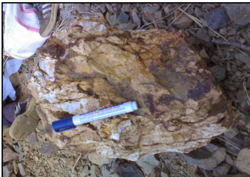
تصویر ۵۰: برش دگرسان شده هماتیته - لیمونیتی نمونه 342-8
