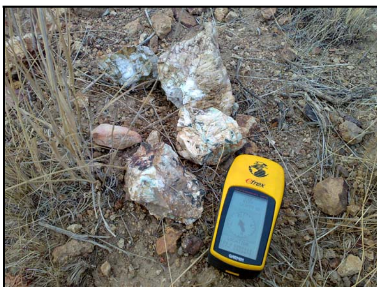
تصویر ۳۲: نمایی نزدیک از کانی‌سازی مس - باریت - آهن در محل نمونه KM-292-6
