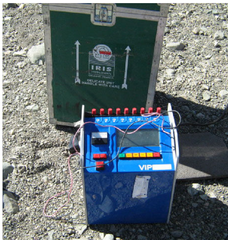
تصویر شماره ۱۰- ترانسمیتر VIP ساخت شرکت IRIS فرانسه
