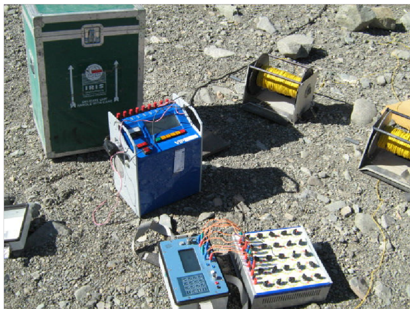
تصویر شماره ۹- مجموعه رسیور و ترانسمیتر به همراه سویچ باکس و سیمهای فرستنده جریان
