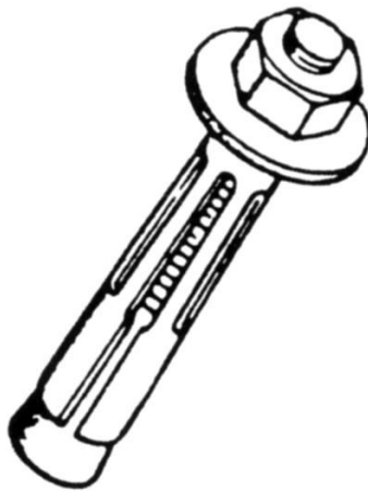
شکل پ-۴ طرحواره پیچ از نوع بست غلاف‌دار
