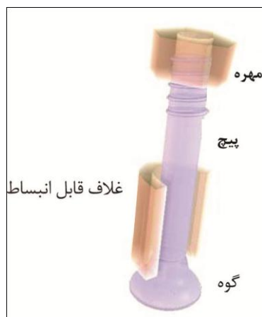
شکل پ-۲ طرحواره پیچ از نوع گوه‌ای
