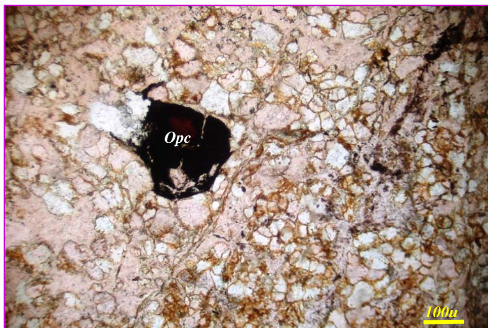
تصویر ۵-۲۰- مقطع CT-458-3، شکستگی‌های نمونه با کانی‌های اپاک پر شده‌اند، نور عادی، 4×10X
