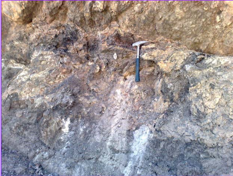
تصویر ۵-۲۵- نمایی از مکان برداشت نمونه‌ی CL-504 در داخل سنگ آهک و شیست که دارای کانه‌های اکسید آهن می‌باشد.
