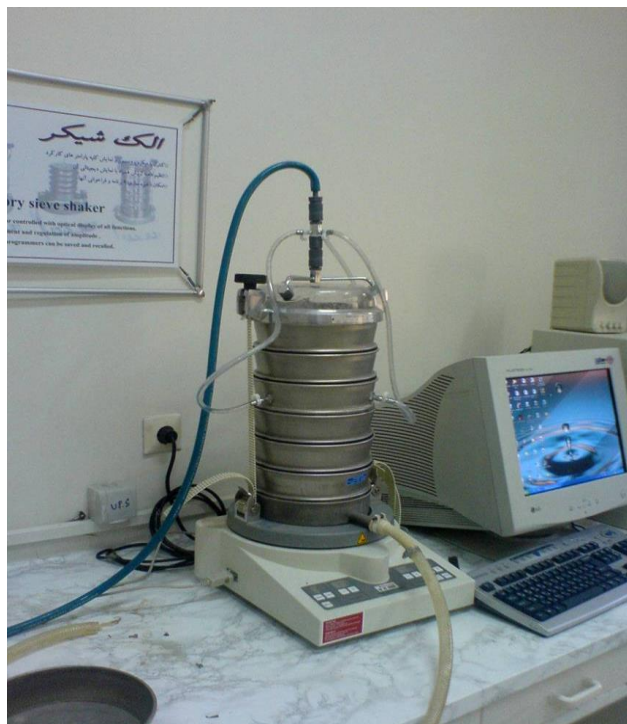
شکل 1-1 دستگاه الک شیکر برای دانه بندی رسوبات به روش مرطوب
