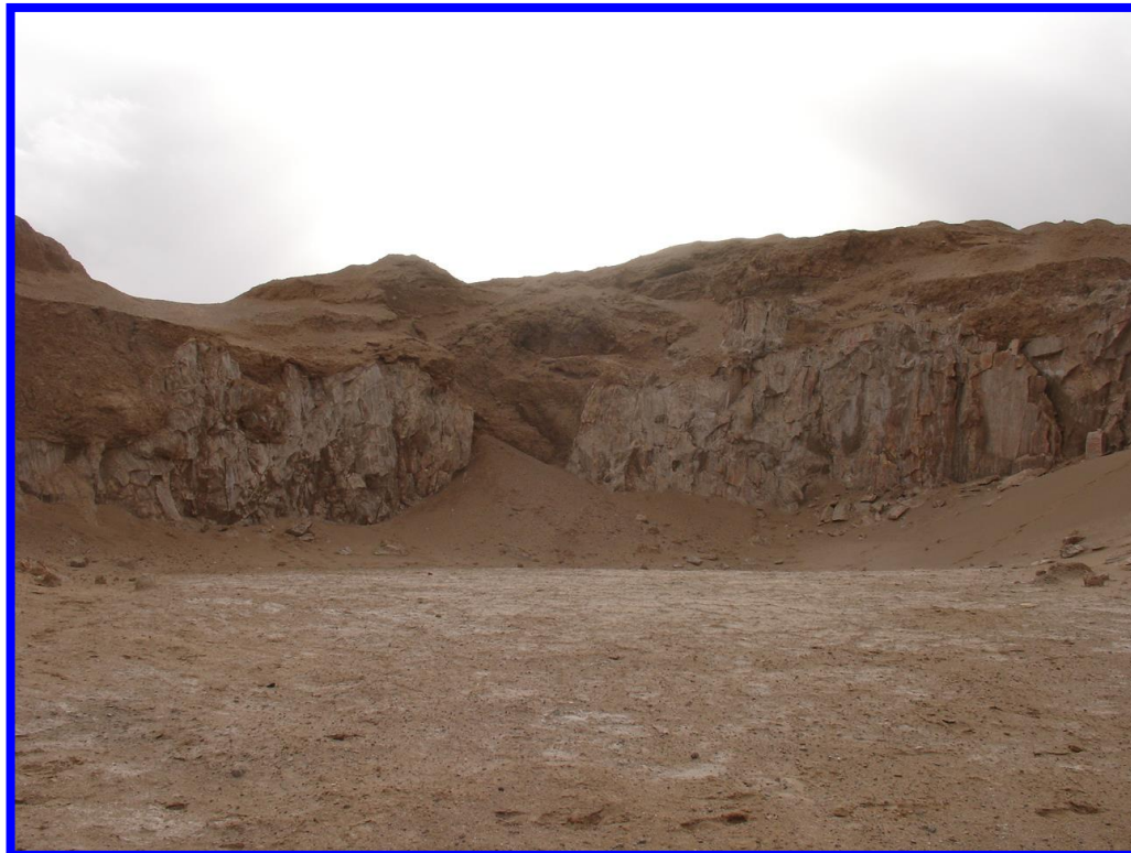
تصویر شماره 70: نمایی از سینه کار معدن متروکه حاجی آباد و محلی که امتداد نمک قطع شده است. کف کارگاه توسط رس همراه با ترکهای گلی و بخشی از رخنمون نمک در دیواره توسط ماسه بادی پوشیده شده است. (نگاه به سمت جنوب)
