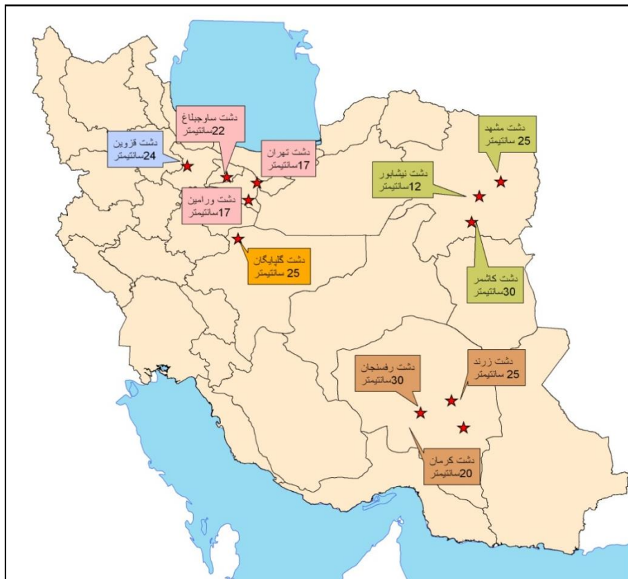
شکل ۵-۸- نقشه برآورد بیشینه نرخ فرونشست دشت‌ها (سازمان زمین‌شناسی و اکتشافات معدنی کشور)
