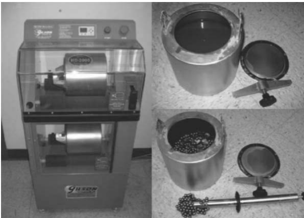
شکل ۱- نمایی از ابزار آزمایش میکرو دوال و وضعیت مصالح سنگی در قبل و بعد از آزمایش
