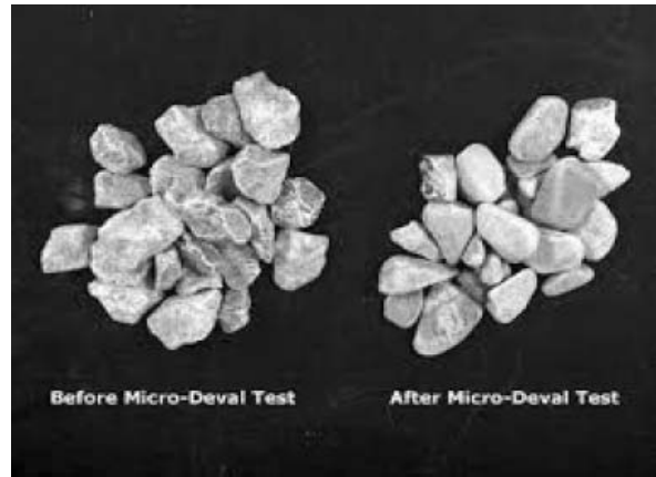
شکل ۱- نمایی از ابزار آزمایش میکرو دوال و وضعیت مصالح سنگی در قبل و بعد از آزمایش
