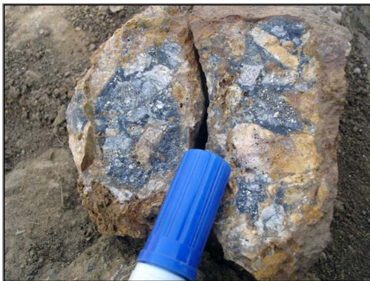
شکل ۳-۸- نمایی نزدیک از برشهای هیدروترمالی حاوی کانی سازی سولفیدی فراوان در رگه ZV1
