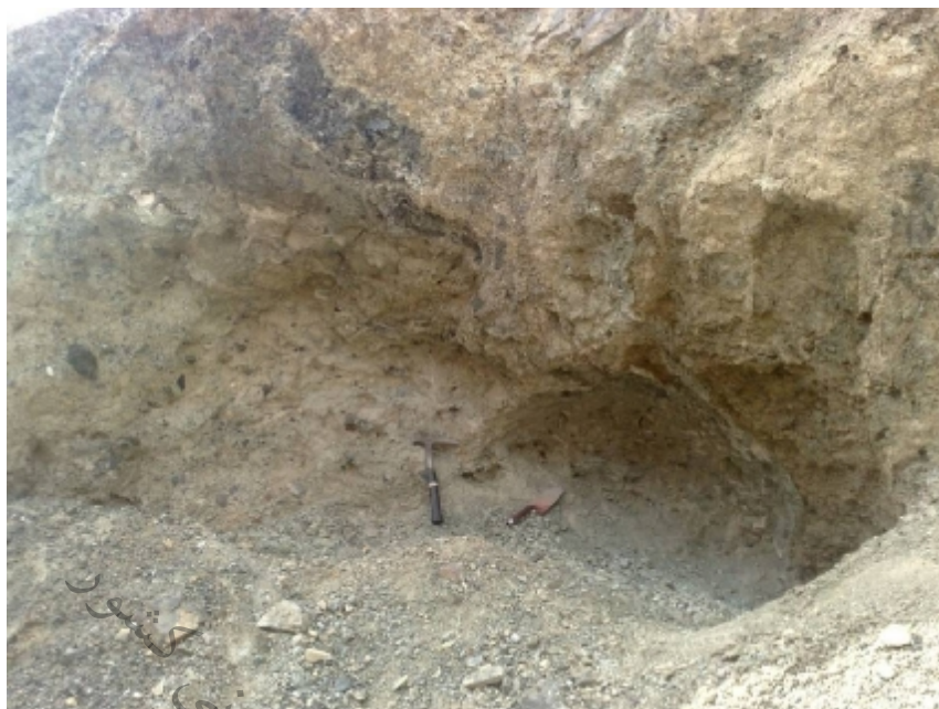
شکل 4-9- حفاری قدیمی برای دسترسی به لنزهای کرومیت
