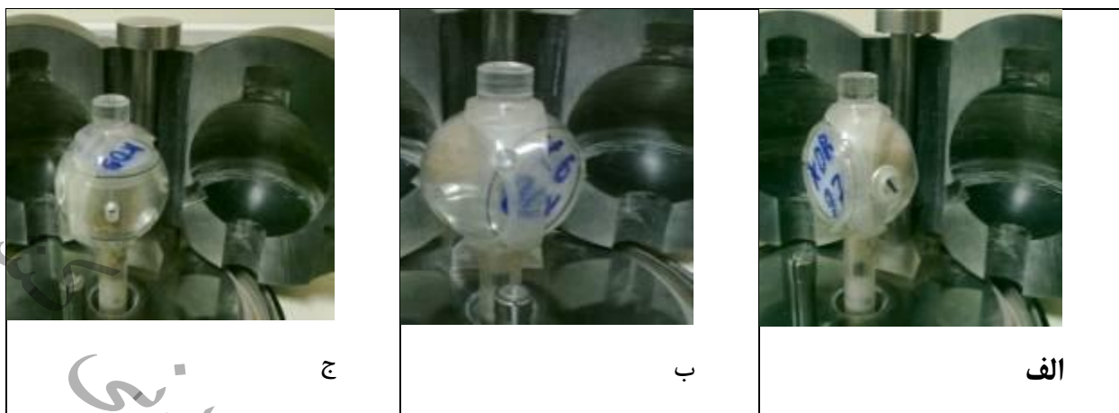
شکل ۳-۳: نحوه اندازه گیری پسماند مغناطیسی (الف) امتداد محور XZ؛ (ب) امتداد محور YZ؛ (ج) امتداد محور XY
