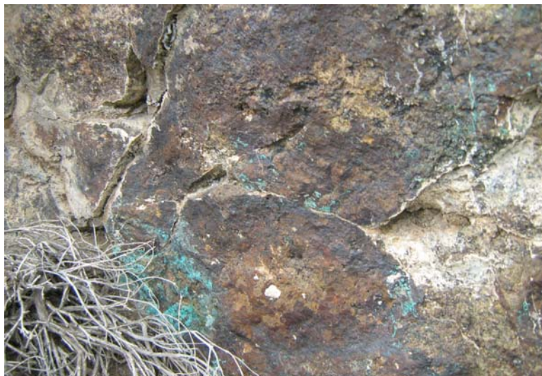
شکل ۳-۳۷- الف- کانه زایی بصورت مالاکیت در بخش اسکارنی
