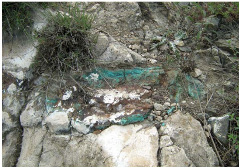
شکل ۳-۳۷- الف- کانه زایی بصورت مالاکیت در بخش اسکارنی
