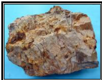
شکل 91- پیریت بصورت رگه و رگچه همراه اکسیدهای آهن .
