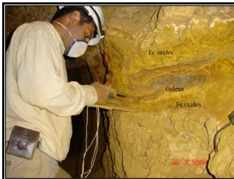
شکل 74- نمایی از کانه‌سازی گالن سولفیدی بصورت ماسیو و دانه‌ریز که توسط اکسیدهای آهن و اکسیدهای سفیدرنگ روی احاطه شده است.
