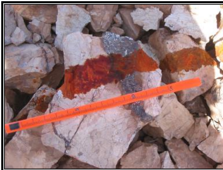
شکل 76- گالن بصورت رگه‌ای که توسط کانه‌سازی اکسیدی روی (سفیدرنگ) در بر گرفته شده است.
