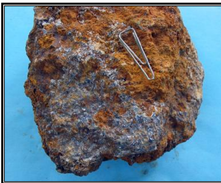
شکل 76- گالن بصورت رگه‌ای که توسط کانه‌سازی اکسیدی روی (سفیدرنگ) در بر گرفته شده است.
