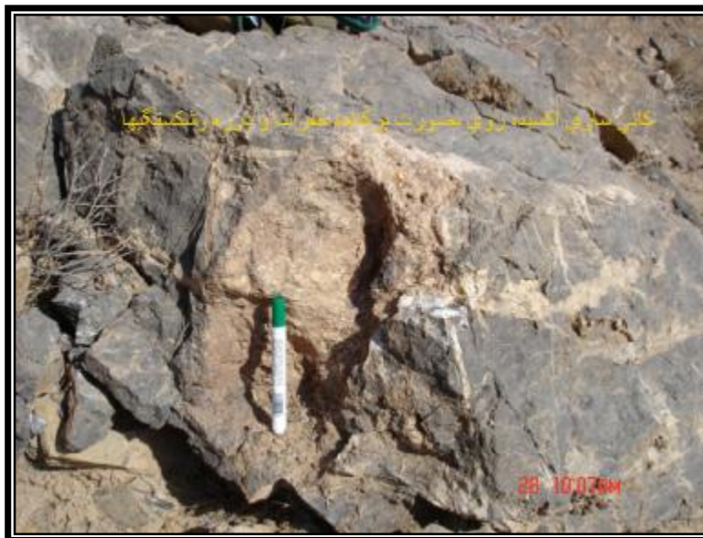
شکل 61- نمایی از کانی‌سازی روی (سفیدرنگ چرکی + اکسیدهای آهن) که بصورت پرکننده حفرات و درزه شکستگی در واحد A12 مشاهده می‌شود.
