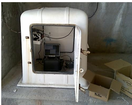
شکل ۷-۴ شتابنگار نصب شده در تکیه گاه راست و تاج سد
