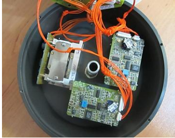
شکل ۳-۲ شتابنگار گورالپ CMG-5TD (راست) و نمایی از ۳ مولفه سنسور شتابسنج CMG-5TD گورالپ (چپ)
