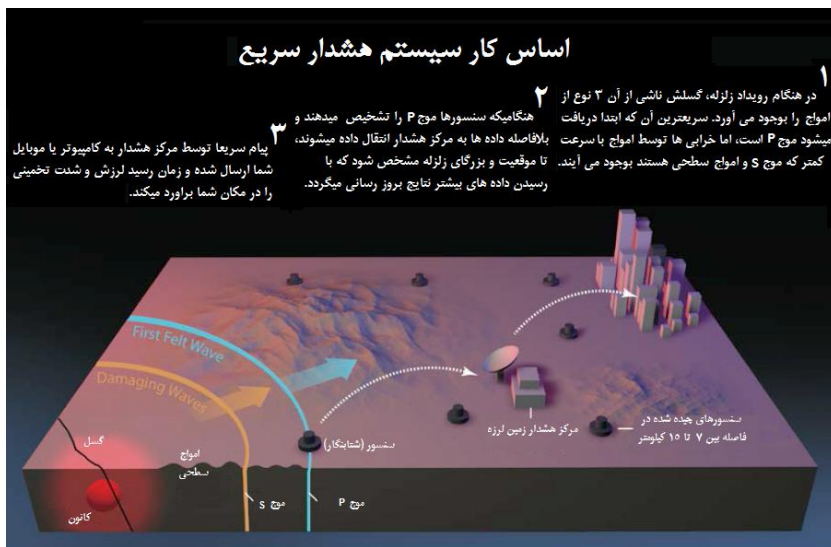
شکل ۵-۲۱ اساس کار سیستم هشدار سریع برگرفته از usgs
