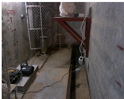
شکل ۸-۴ دستگاه شتابنگار نصب شده در گالری های سد
