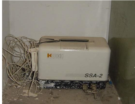
شکل ۳-۲۵ شتابنگار SSA-2 نصب شده در فرمانداری بم که رکورد مهم نزدیک گسل زمین لرزه بم را با بیشینه شتاب 0.9g ثبت نمود (راست) به همراه محتوای داخلی دستگاه (چپ)
