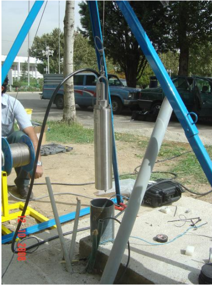
شکل ۴-۱۵ سنسور درون چاهی قبل از نصب در گمانه
