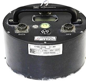
شکل ۳-۲ شتابنگار گورالپ CMG-5TD (راست) و نمایی از ۳ مولفه سنسور شتابسنج CMG-5TD گورالپ (چپ)
