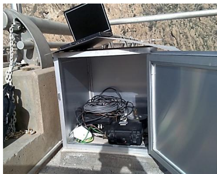
شکل ۷-۴ شتابنگار نصب شده در تکیه گاه راست و تاج سد
