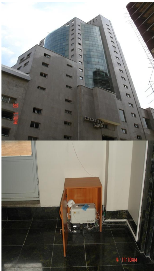
شکل ۴-۱۱ ساختمان مرکزی شرکت آب و نیروی ایران (بالا) به همراه نمونه‌ای از دستگاه شتابنگار نصب شده (پایین)
