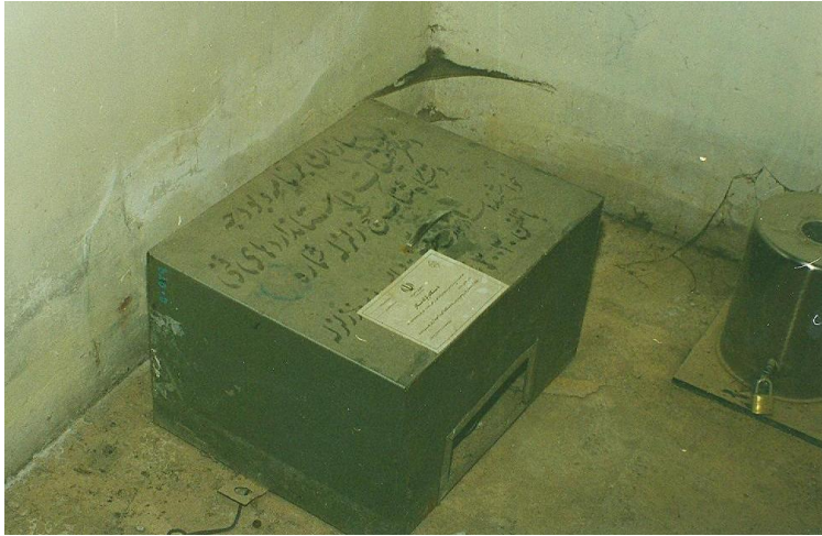
دستگاه شتابنگار SMA-1 (چپ) به همراه لرزه‌نگار ویلموت (راست) - (عکس از علی اکبر بداغی)
