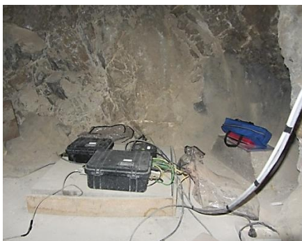
شکل ۸-۴ دستگاه شتابنگار نصب شده در گالری های سد
