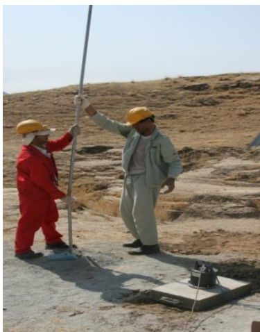
شکل ۴-۱۹ نصب تجهیزات ثبت ارتعاشات ناشی از انفجار
