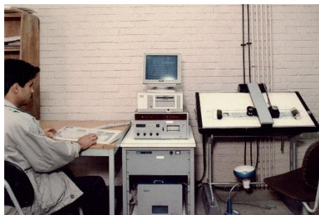
شکل ۳-۹ پرسنل شبکه شتابنگاری و تجهیزات رقومی کردن داده‌های شتابنگاری در دهه شصت و هفتاد خورشیدی
