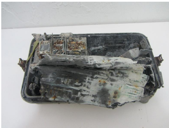
دستگاه شتابنگار SSA-2 ایستگاه روستای ابر که در اثر آتش‌سوزی ناشی از صاعقه از بین رفت (عکس از آرشیو شبکه شتابنگاری)
