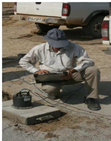
شکل ۴-۱۹ نصب تجهیزات ثبت ارتعاشات ناشی از انفجار
