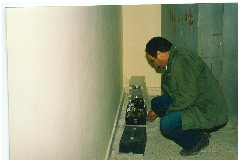
علی اکبر بداعی، کارشناس شبکه شتابنگاری در حال تنظیم دستگاه SMA-1 و آردتا (عکس از علی اکبر بداعی)
