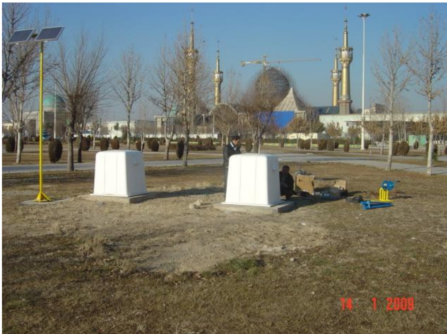
شکل ۴-۱۶ آرایه درون چاهی نصب شده در مرقد امام
