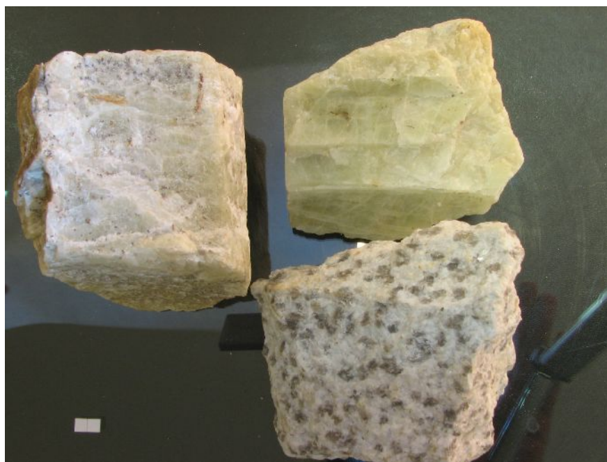
تصویر ۲-۶۸: نمونه‌های دستی پگماتیت ریز بلور (پائین) بریل (بالا) و فلدسپات (سمت چپ)
