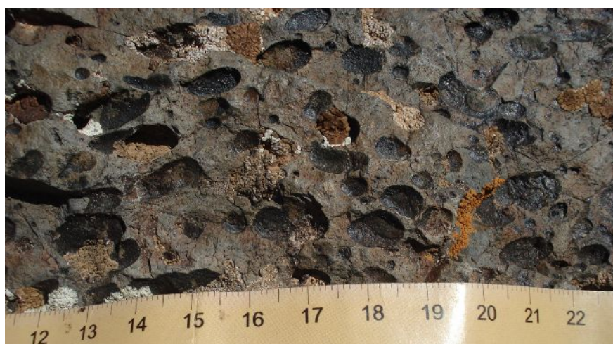
تصویر ۲-۸۷: بافت آمیگدالوئیدی گدازه‌های ولکانیکی که توسط اکسیدهای آهن پر شده است.
