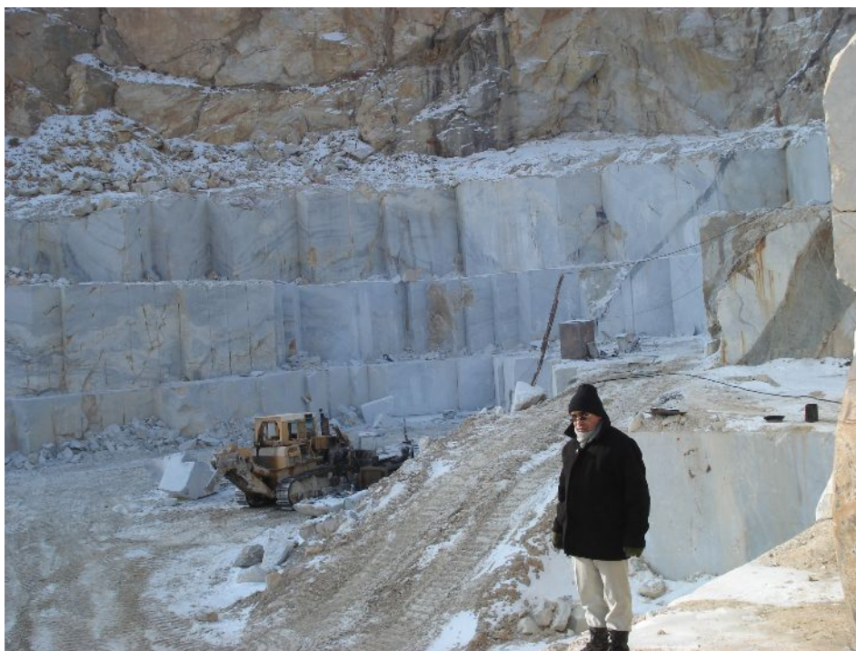
تصویر ۲-۶۱: نمایی از سینه‌کار معدن کریستال قروه (استخراج با روش سیم برش)
