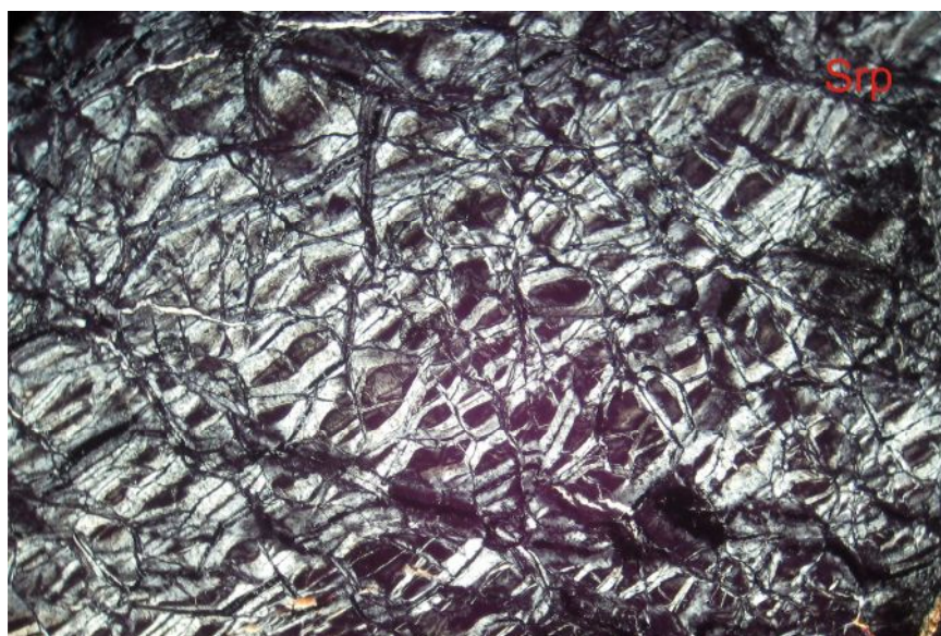
نگاره ۱: سرپانتین به صورت مشبک. در وضعیت نوری XPL. (بزرگنمایی 40X)
