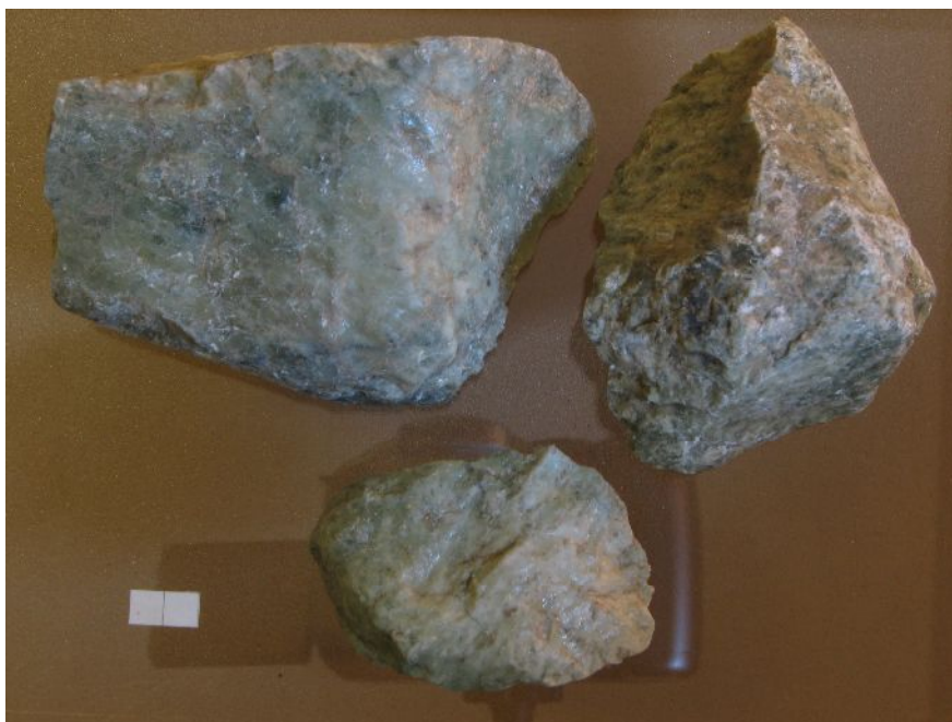
تصویر ۲-۸۴ : تالک در نمونه‌های دستی از افیولیت‌های توانکش - هزار
