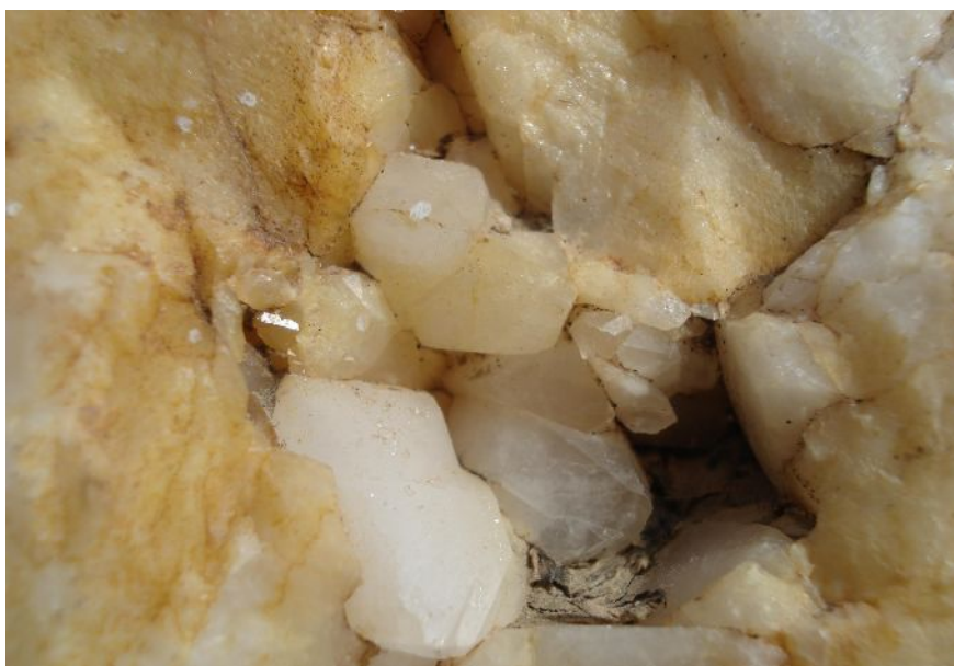
تصویر ۲-۲۴: بلورهای در کوهی در فضاهای خالی بخش مرکزی رگه‌های کوارتز شیری به صورت ساخت دندان‌شانه‌ای
