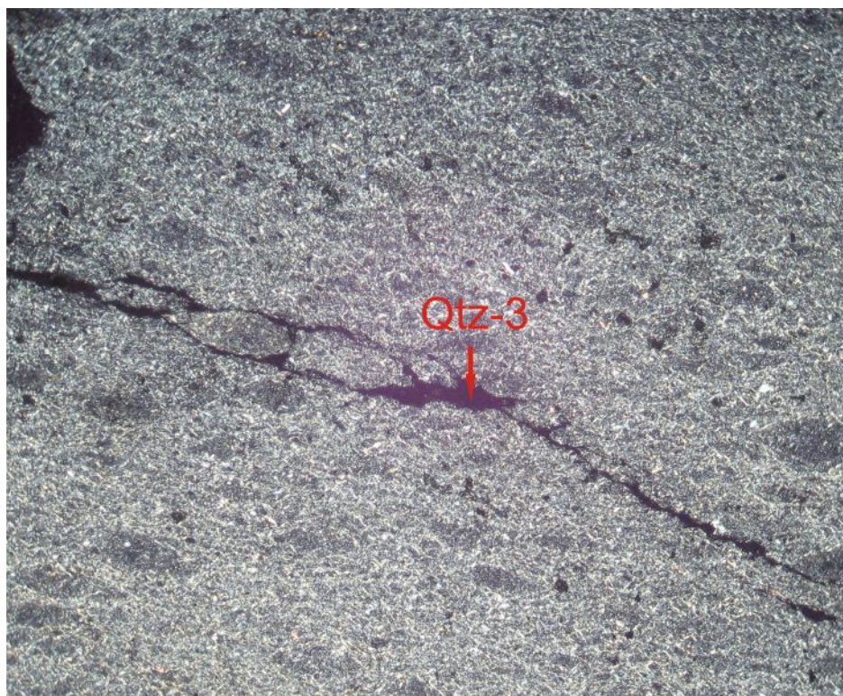
نگاره ۶: کوارتز نسل سوم به صورت پراکنده ریز درزه‌ها. در وضعیت نوری XPL. (بزرگنمایی 40X)
