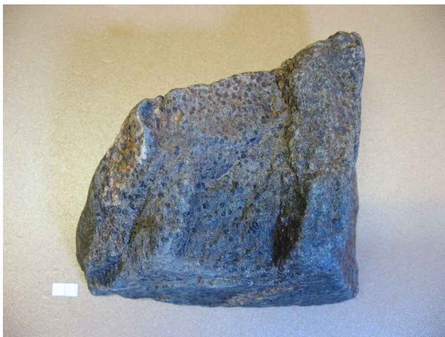
تصویر ۲-۶۰: نمونه دستی از شیبستهای حاوی بلورهای کانی ایلمنیت ناحیه آصف‌آباد (مقیاس عکس ۱ سانتیمتر می‌باشد)
