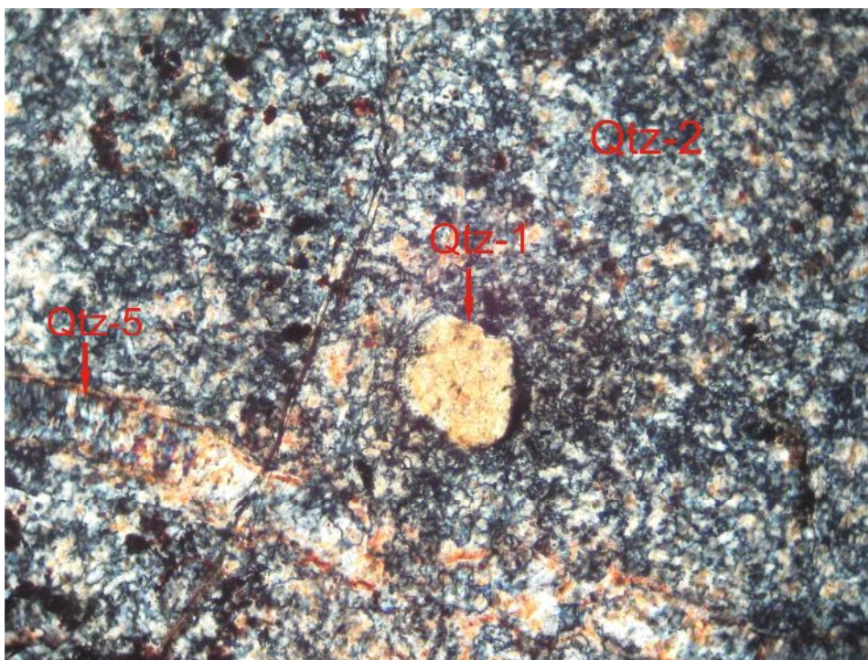
نگاره ۱: زایش های متفاوت کوارتز. در وضعیت نوری XPL. (بزرگنمایی 40X)
