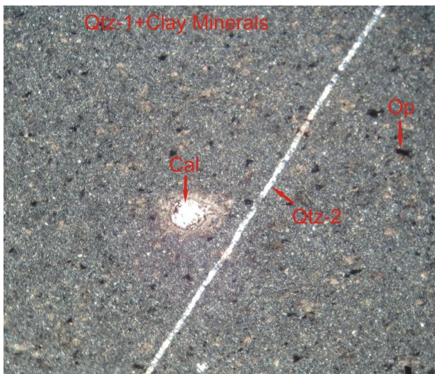
نگاره ۷: زایش های متفاوت کوارتز و کانی های رسی. در وضعیت نوری XPL. (بزرگنمایی 40X)
