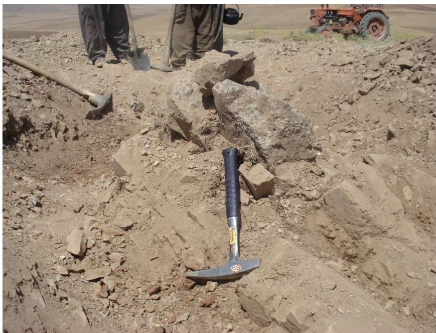
تصویر ۲-۱۲ : عملیات حفر ترانشه بر روی برونزد ژاسپ سبز رنگ لایه‌ای جهت تعیین گسترش آن
