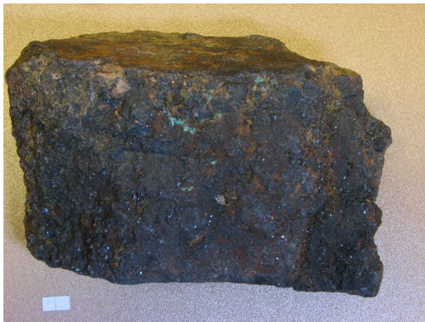
تصویر ۲-۴۱: تجمع بلورهای منیتیت همراه با هماتیت و کانی‌های ثانویه مس در نمونه دستی ماده معدنی
