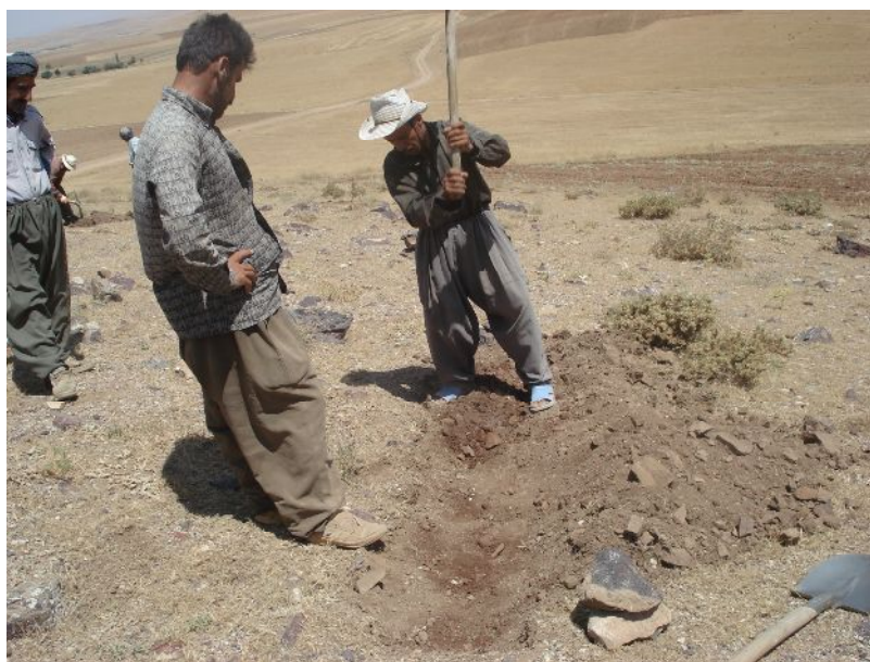
تصویر ۲-۱۱: برونزد ژاسپ سرخ رگه‌ای و عملیات حفر ترانشه جهت تعیین گسترش آن
