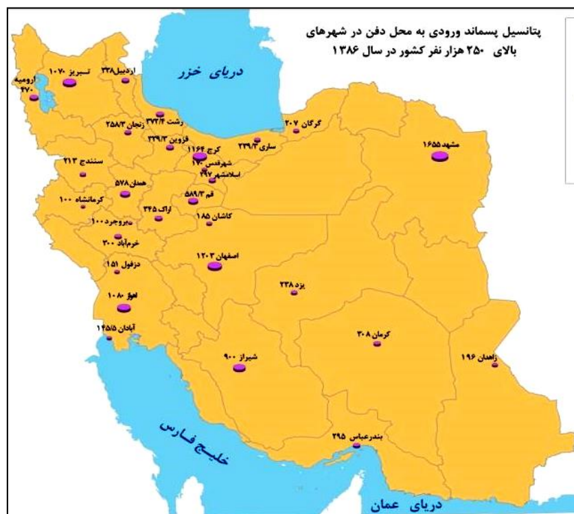
شکل ۱-۱۸- پتانسیل پسماند ورودی به محل دفن زباله (بر حسب تن در روز) (وزارت نیرو-سازمان انرژی‌های نو)
