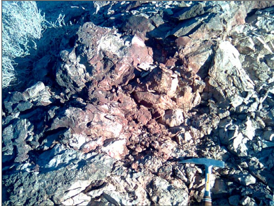
شکل (۳-۴۲) : آلتراسیون آرژیلیکی در حد کائولن حاوی دانه های کوارتز
