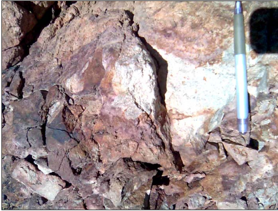
شکل (۳-۱۷): آثاری از اکسید آهن و پیریت به همراه آلتراسیون کائولینیتی
