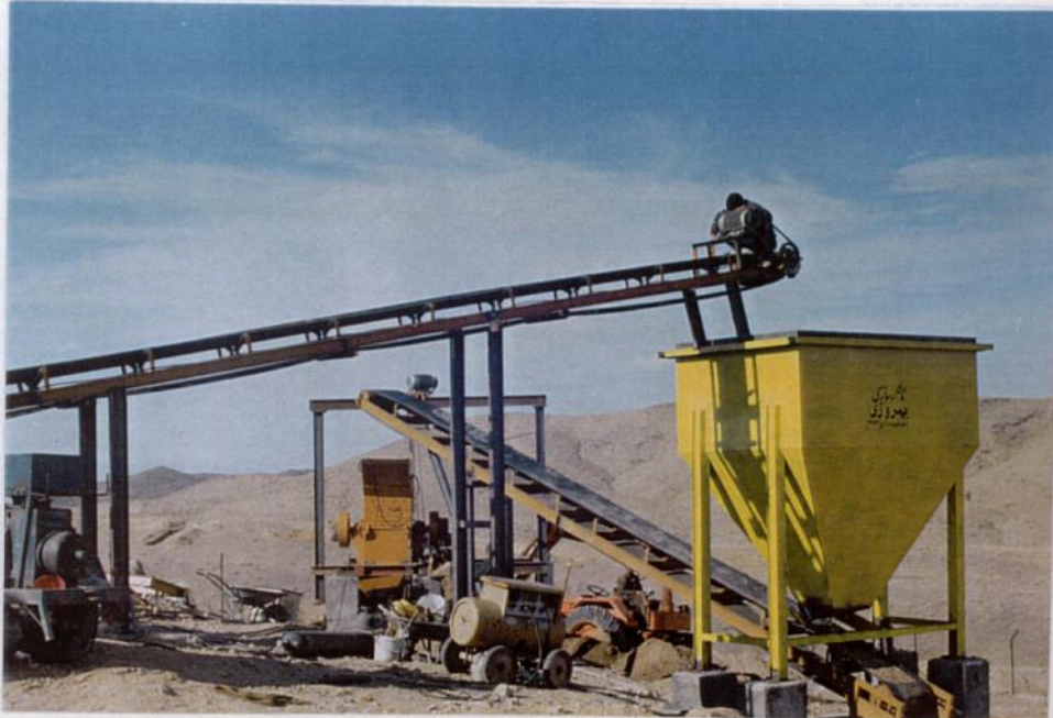
عکس ۲- جانمایی نوار نقاله ها و بونکر و شکن چکشی
