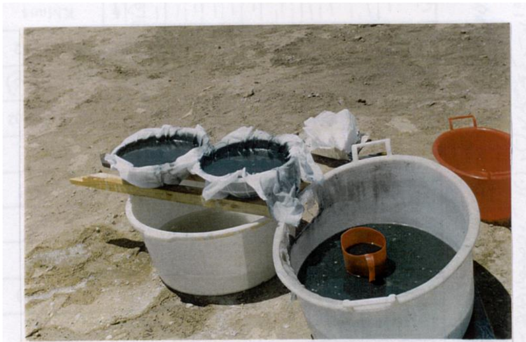
عکس ۱۱- نمایی از فیلتراسیون لجن برجای مانده از عملیات لیچینگ فویل های روی حاوی طلا
