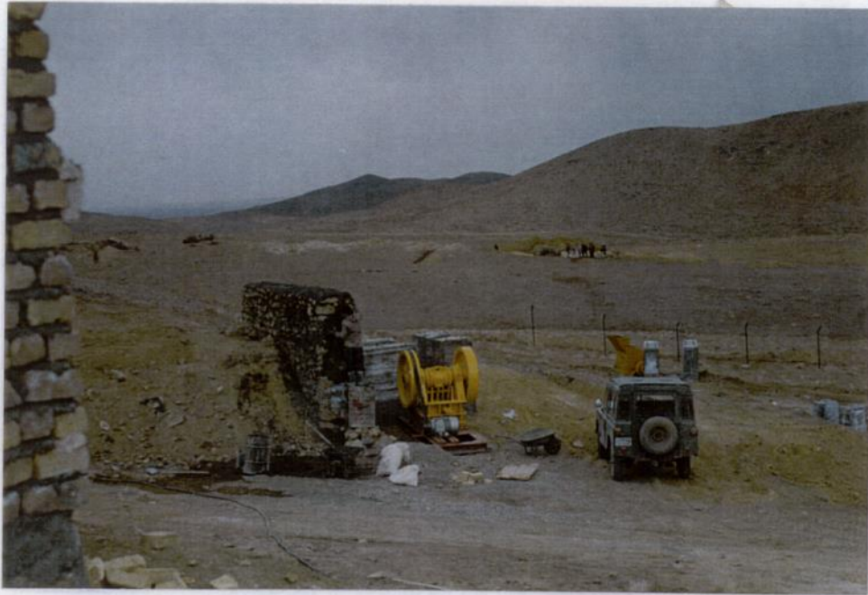
عکس ۱- نمایی دور از سنگ شکن چکشی (۲۴ چکش) و سنگ شکن فکی مدل (Blake)
