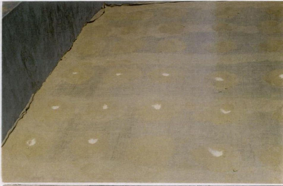
عکس ۵- کف حوضچه لیجینگ و نحوه افزودن پراکسید سدیم \text{Na}_2\text{O}_2
