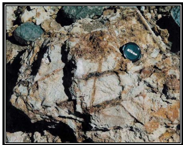
تصویر شماره ۲۲-۳- دو نمونه از زون استوکورک، در نمونه سمت چپ کانی‌سازی مس انجام شده است.
