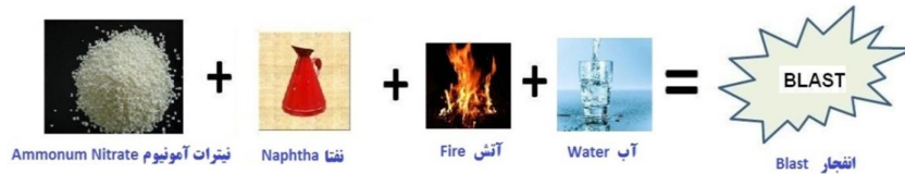
شکل ۲۱: ترکیبات ناشی از انفجار نیترات آمونیوم در سانحه انفجار ایستگاه راه‌آهن خیام
