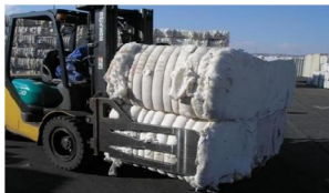
شکل ۱۴: تصاویری از جایجایی عدل پنبه توسط لیفتراک با بازوهای هیدرولیکی
