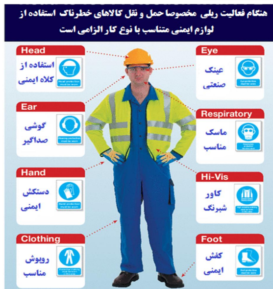
شکل ۶: هنگام انجام فعالیت مخصوصاً حمل و نقل کالای خطرناک استفاده از لوازم ایمنی الزامی است.
