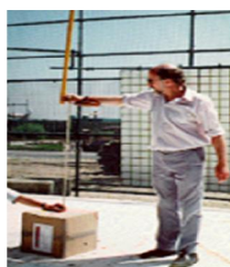
شکل ۱۰: تست نفوذ (سقوط میله ۶ کیلوگرمی با قطر ۳۳ میلی متر از ارتفاع ۱ متری).
