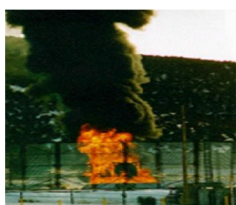
شکل ۸: بسته کلاً در داخل آتشی با دمای حداقل ۸۰۰ درجه سانتی گراد به مدت ۳۰ دقیقه، سوزانیده می‌شود.
