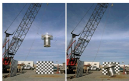
شکل ۹: سقوط از ۹ متری بر روی سطح صلب
