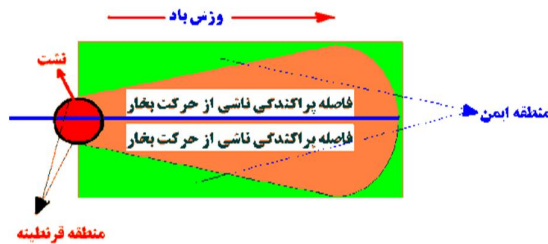
شکل ۱۵: تصویر شماتیک مناطق ایمن و قرنطینه هنگام نشت مواد خطرناک
