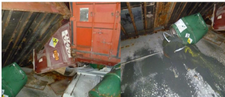
شکل ۱: آلودگی واگن و محیط توسط مواد کلاس ۷ (مواد رادیو اکتیو، ماده هسته ای و یا ...)
