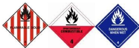
شکل ۶: برجسب‌های کلاس چهار خطر شامل جامدات قابل اشتعال، مواد خود اشتعال، موادی که در تماس با آب ایجاد گازهای قابل اشتعال می‌کنند.
