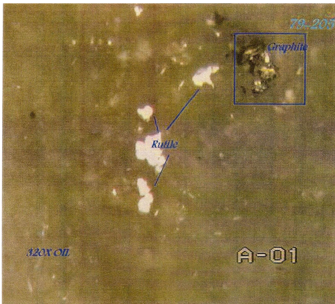
- بلور گرافیت و بلورهای روتیل را در نمونه UR-70 بوضوح مشاهده می‌نماییم
