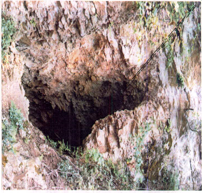
عکس ۱۱ - دهانه تونل سوم ( افق ۲۱۵۰ + متری ) کانسار چومول (نگاه به سمت شمال شرق ) زون لیمونیتیزه به خوبی دیده میشود .
