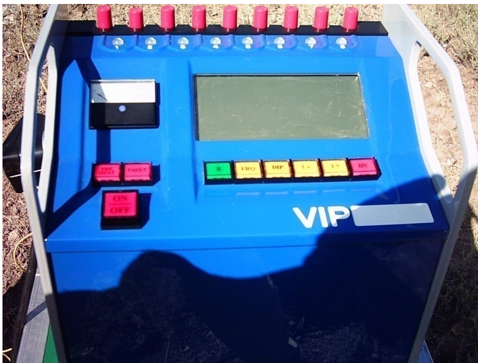
تصویر شماره ۱۰- ترانسمیتر VIP ساخت شرکت IRIS فرانسه
