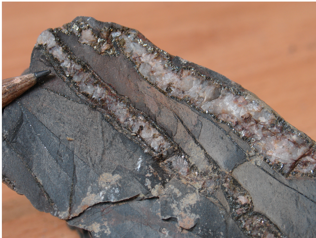
شکل ۳-۲۹-نمایی نزدیک از رگچه‌های سیلیسی-پیریتی در ترانسه ۱۲ که پیریت اغلب در حاشیه قرار گرفته است.
