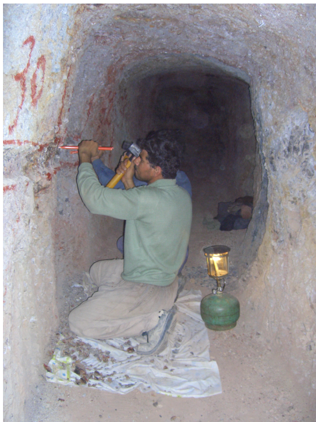
شکل ۳-۱۲- نمونه برداری شکاری از دیواره تونل قدیمی چاه پلنگ
