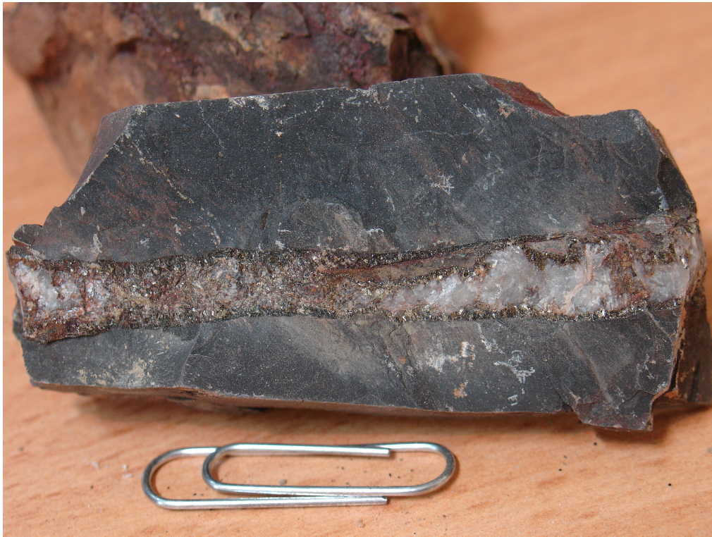
شکل ۳-۲۸-نمایی نزدیک از رگچه‌ای سیلیسی-پیریتی از ترانسه ۱۲ که در آهن پیریت در حاشیه رگچه قرار گرفته و در حال تجزیه به
