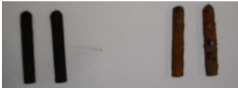
شکل ۳-۱۲: الکتروود خوردگی در مسیر بسته و در حال چرخش در پکیج (تصویر سمت چپ)، در برج خنک کن (تصویر سمت راست).
