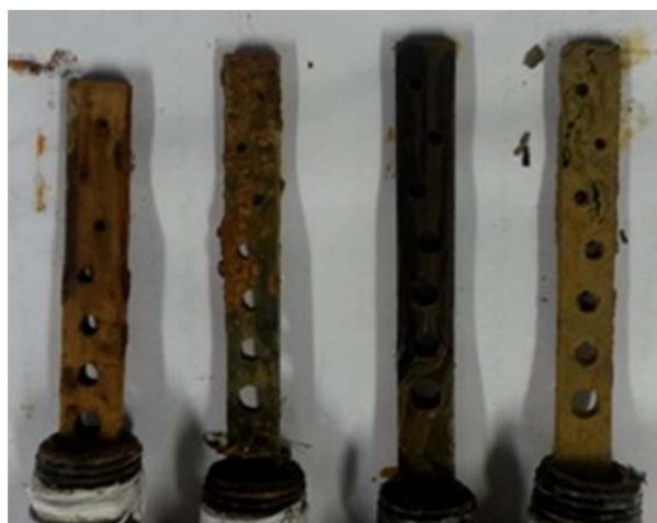
شکل ۳-۲۳: تصویر کوپن‌های رسوبگذاری برای آب نرم شده توسط سختی گیر اسمز معکوس (RO). به ترتیب از راست به چپ (۱: برج ، ۲: پکیج ، ۳: آب گرم مصرفی ، ۴: ورودی)
