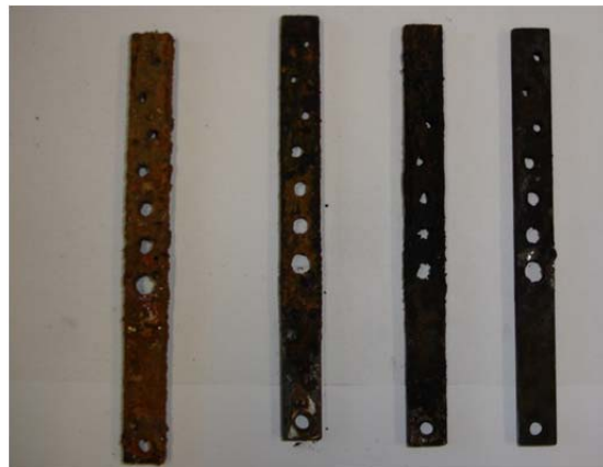
شکل ۳-۱۱: تصویر کوپن‌های رسوب‌گذاری برای آب نرم شده توسط سختی‌گیر اسمز معکوس (RO). به ترتیب از راست به چپ (۱: پکیج، ۲: ورودی، ۳: آب گرم مصرفی، ۴: برج خنک کن)
