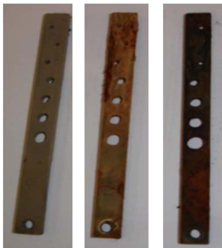
شکل ۳-۲۶: تصویر کوپن‌های رسوبگذاری برای آب نرم شده توسط سختی‌گیر الکترومغناطیسی. به ترتیب از راست به چپ (۱: پکیج، ۲: ورودی، ۳: برج خنک‌کن)
