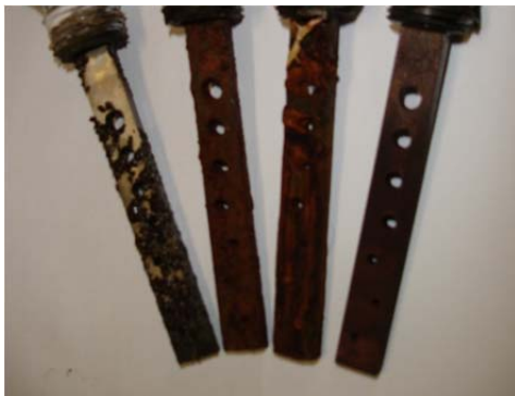
شکل ۳-۸: تصویر کوپن های رسوب گذاری برای آب نرم شده توسط سختی گیر رزینی به ترتیب از سمت راست: ۱- برج، ۲- آب گرم مصرفی، ۳- آب ورودی به پکیج و برج پس از سختی گیر، ۴- پکیج
