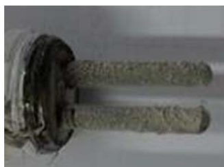
شکل ۳-۱۸: الکتروود خوردگی در مسیر بسته و در حال چرخش برج خنک کن
