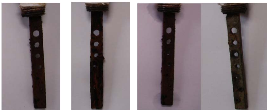
شکل ۳-۲۰: تصویر کوپن‌های رسوب گذاری برای آب با عبور از سختی گیر رزینی بعد از دو ماه. به ترتیب از سمت راست (۱: برج، ۲: آب گرم مصرفی، ۳: ورودی، ۴: پکیج)
