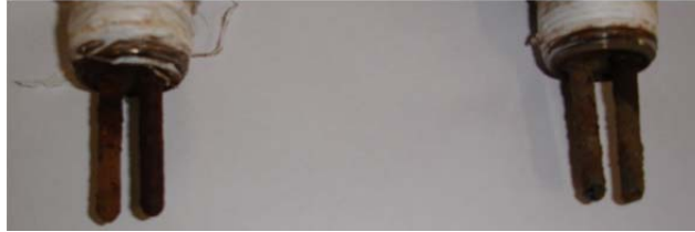
شکل ۳-۲۱: الکتروود خوردگی در مسیر بسته و در حال چرخش پکیج (تصویر سمت چپ)، برج خنک کن (تصویر سمت راست).
