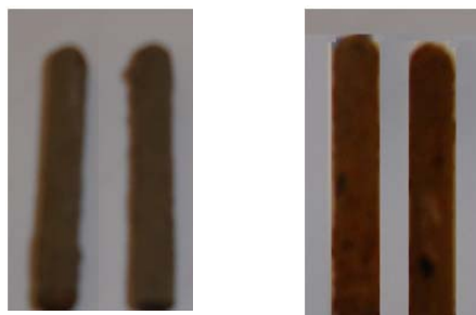
شکل ۳-۲۷: الکتروود خوردگی در مسیر بسته و در حال چرخش پکیج (تصویر سمت راست)، برج خنک‌کن (تصویر سمت چپ).
