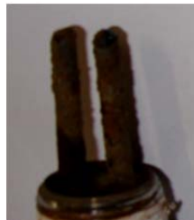
شکل ۳-۲۴: الکتروود خوردگی در مسیر بسته و در حال چرخش پکیج (تصویر سمت چپ)، برج خنک‌کن (تصویر سمت راست).
