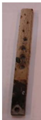
قنات-برج خنک کن- بدون سختی گیر
