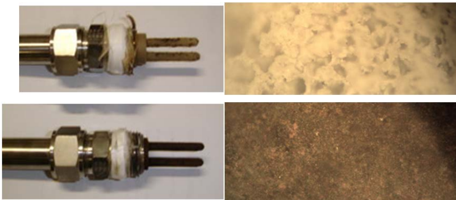
شکل ۳-۶: تصویر بالا: الکتروود خوردگی در مسیر سیکل بسته برج خنک کن، تصویر پایین: الکتروود خوردگی در مسیر سیکل بسته پکیج (تصویرهای سمت راست، تصاویر میکروسکوپی آنها می باشد)
