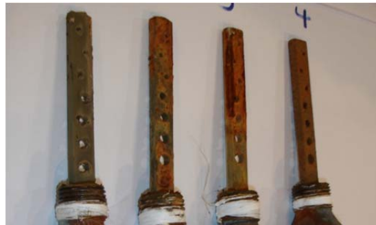
شکل ۳-۱۴: تصویر کوپن‌های رسوب گذاری برای آب نرم شده توسط سختی‌گیر الکترومغناطیسی. به ترتیب از راست به چپ (۱: پکیج، ۲: ورودی، ۳: آب گرم مصرفی، ۴: برج)
