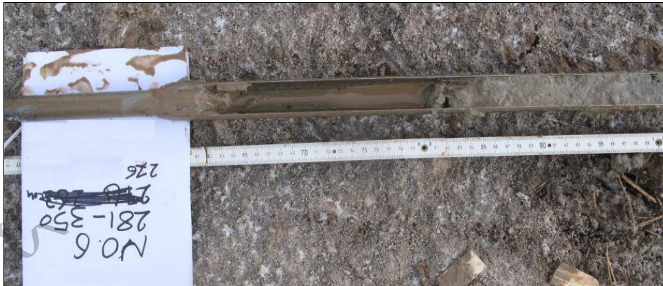
شکل ۲-۱۲. نمونه‌ای از خالی شدن گوج اوگر در رخساره‌های ماسه‌ای اشباع از آب
