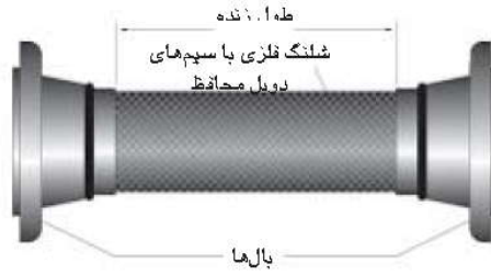
شکل (۶-۴۴) لوله از نوع شلنگ سیمی
