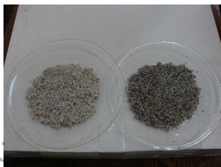
شکل ۶- نمایی از آزمایش جیگ روی نمونه باریت
