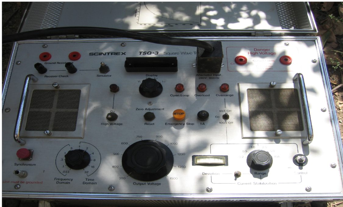
شکل ب - دستگاه ترانسیمتر TSQ-3
