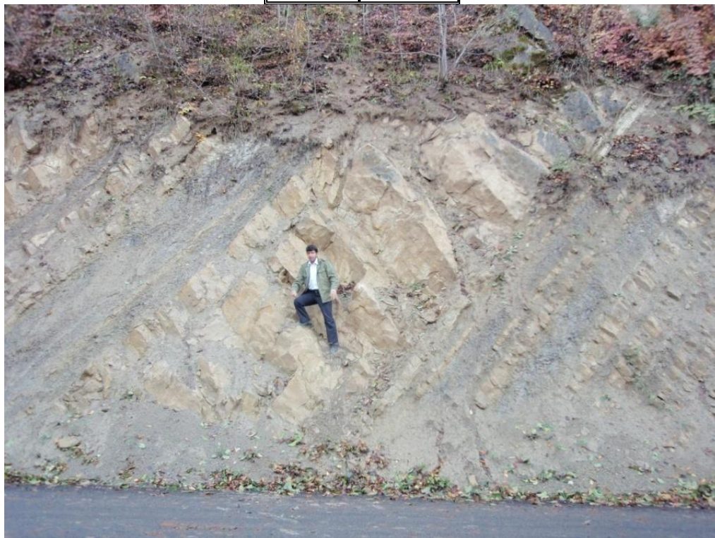
عکس ۲-۲۳-۱: نمایی از رخنمون توده آهکی با درز و شکاف کم واقع در برش کنار جاده (دید به سمت شمال)
