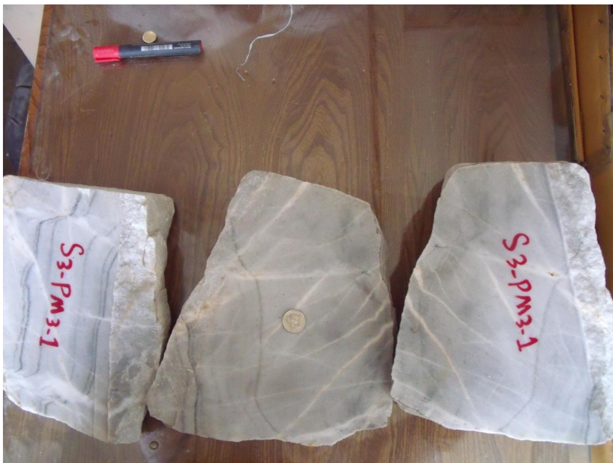
عکس ۲-۳-۲۰: پلاک ساختمانی تهیه شده از نمونه S 3 -PM3-1 برگرفته از ممرهای محدوده S 3 (فاز ۳)
