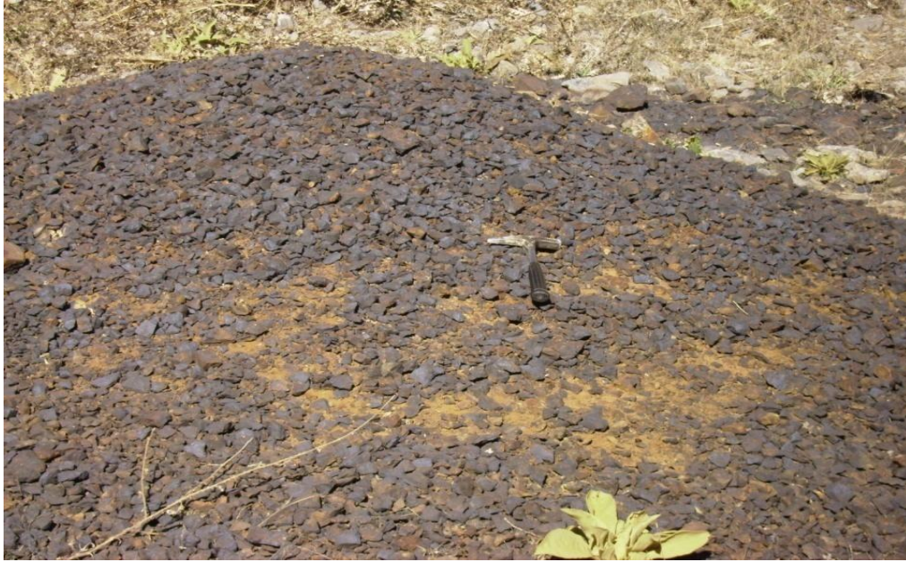
عکس ۲-۱۴-۳: نمایی نزدیک از سنگ آهن مگنتیتی موجود در محوطه معدن متروک نمار
