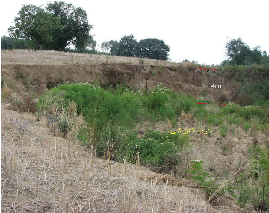
تصویر ۸- توده لغزشی جدیدتر که نسبت به توده اصلی وسعت کمتری دارد و تنده آن حدود ۴ متر می باشد.
