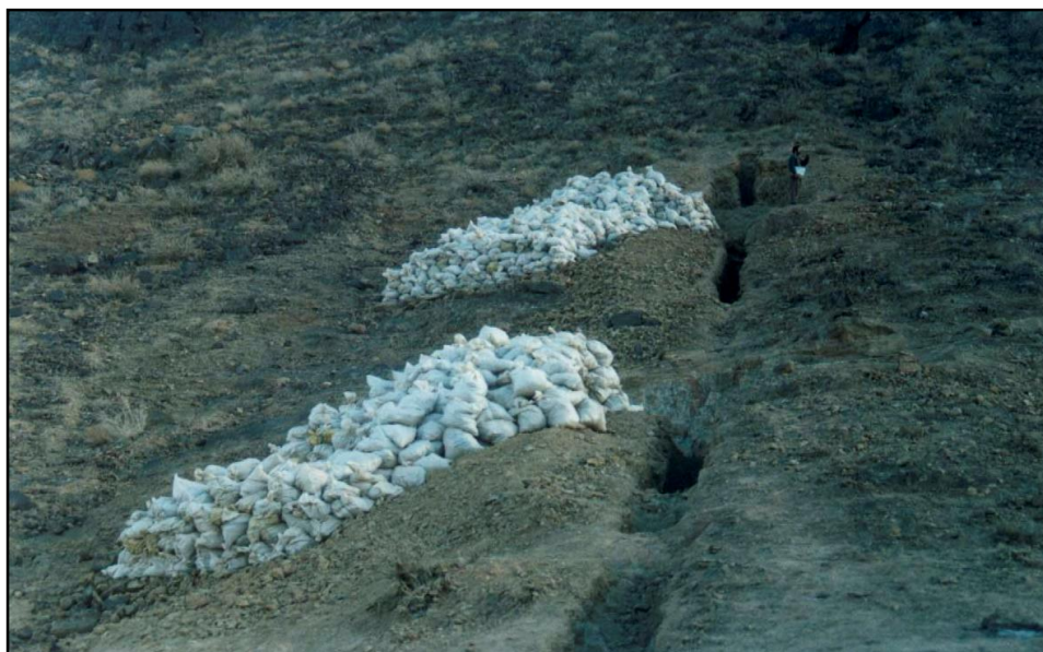
عکس شماره ۳-۳ : نمایی از ترانشه شماره ۳ و استخراج نمونه تکنولوژیکی جهت تست صنعتی
