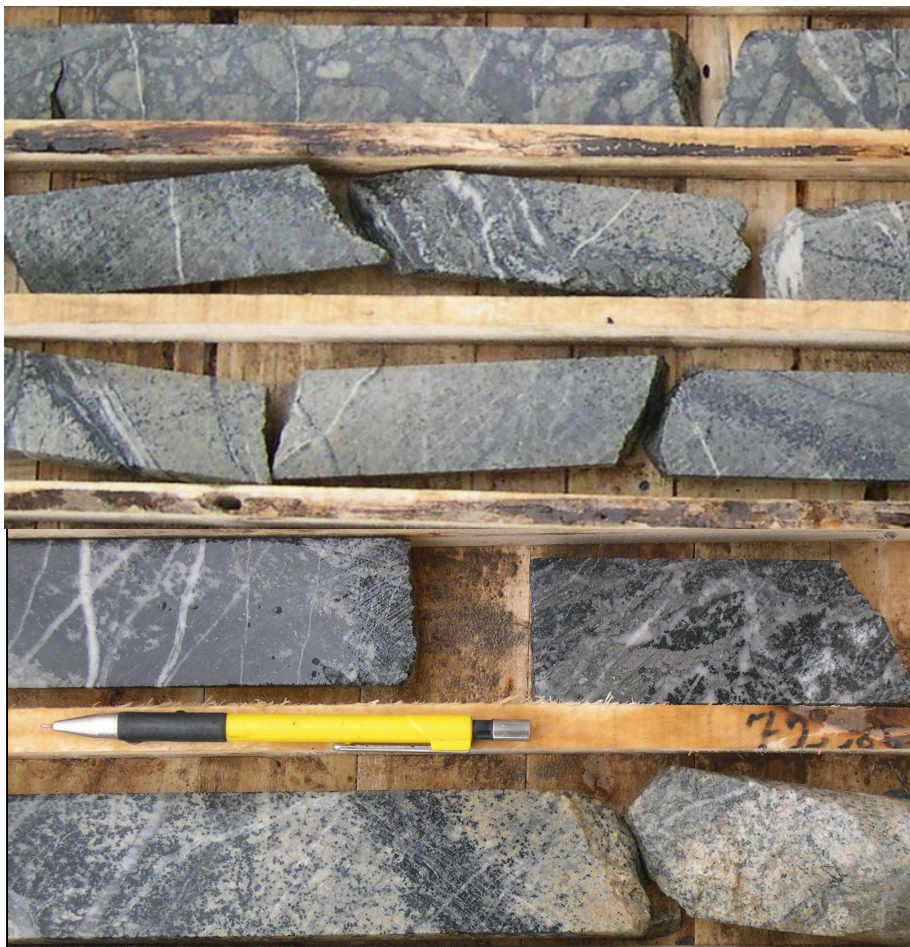
عکس شماره ۴-۳ : بافت برشی، استوک ورگی، پراکنده و توده ای در مغزه های گمانه ۶
