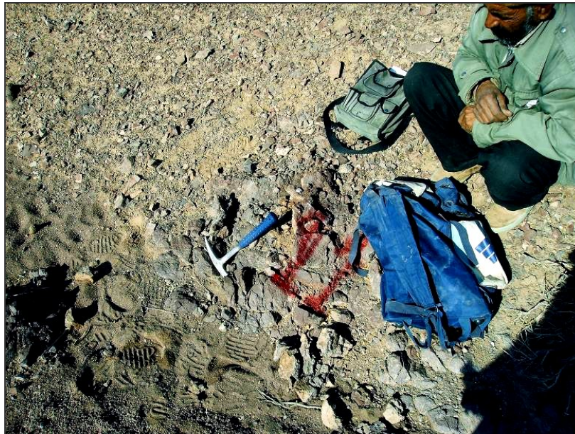
شکل (۳-۹): رخنمون آندزیت های آتره شده حاوی کانه زایی اپیدوت، کلریت و اکسیدهای آهن در شرق چاه کربلایی رضا
