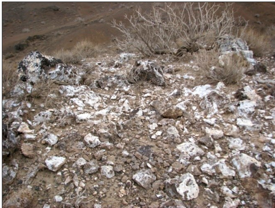
شکل (۳-۴۲): زئولیت کوارتز در داخل آندزیت که بشدت خرد شده است.
