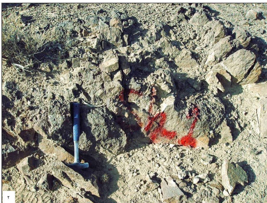
شکل (۳-۳) : برونزدی از یک توده داسیتی تا ریولیتی حاوی اکسیدها ، هیدروکسیدهای آهن و منگنز ؛ شمال شرقی چاه مزار (دید به سمت جنوب)
