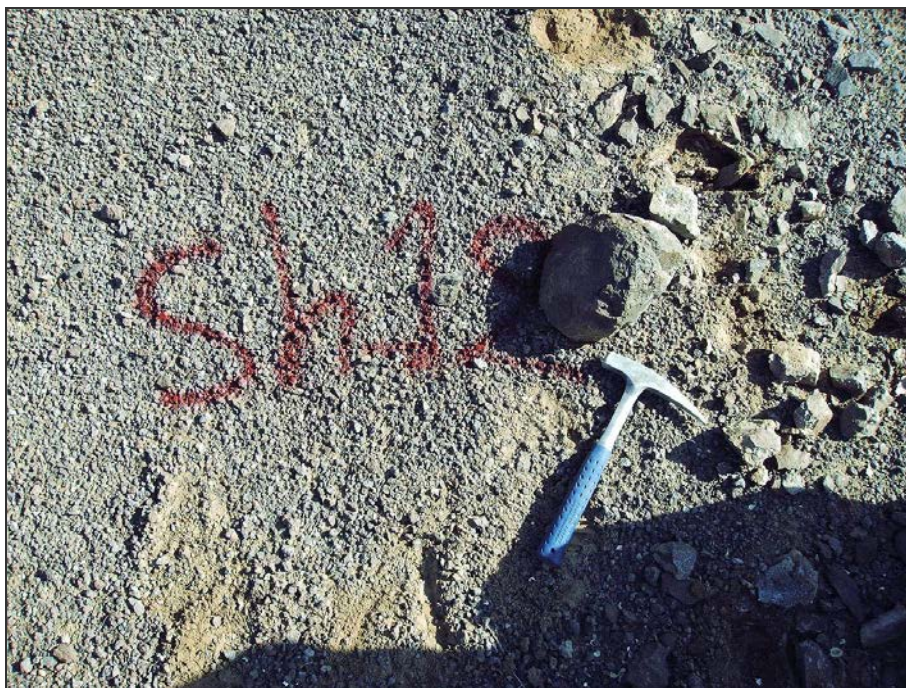
شکل (۳-۱۲): آندزیت های حاوی کانه زایی اکسیدهای آهن و کانه های مس به طور جزئی (شرق چاه کربلایی رضا)
