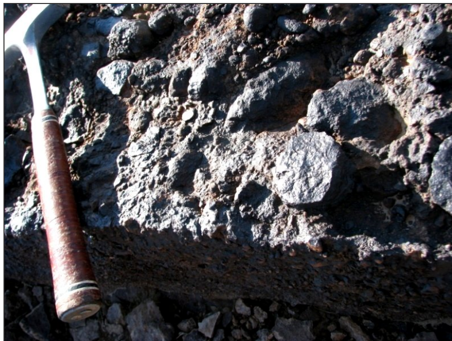
شکل (۳-۳۷): دایک سیلیس دارای اکسید آهن شمال معدن مهر رخس
