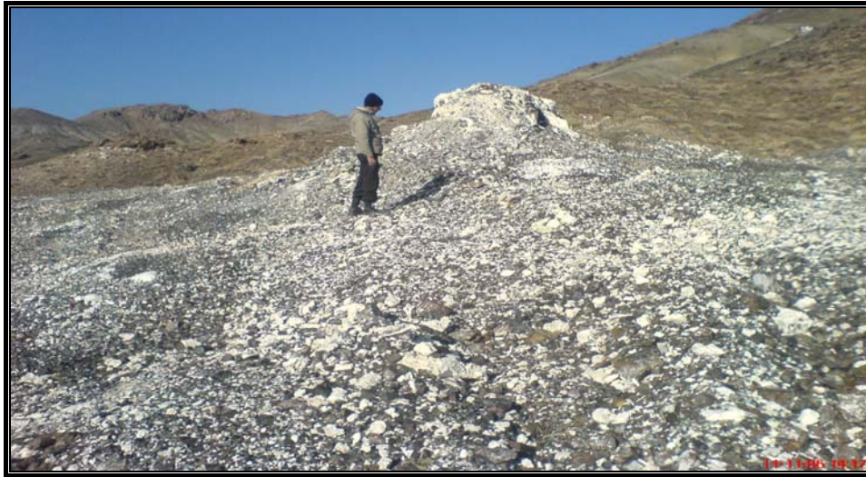
شکل ۳-۹۲- نمایی از یک رگه منیزیته به ضخامت ۱/۲ متر در معدن منیزیته فرومد (نگاه بسمت خاور).
