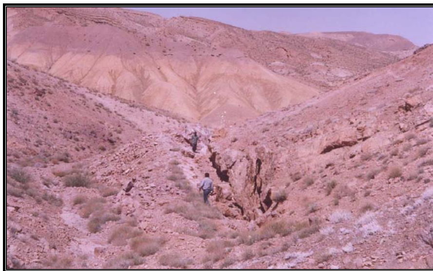
شکل ۳-۱۲۳- دورنمایی از تراشه کارگاه شماره ۴ که در امتداد گسل حفر شده است (نگاه بسمت باختر).
