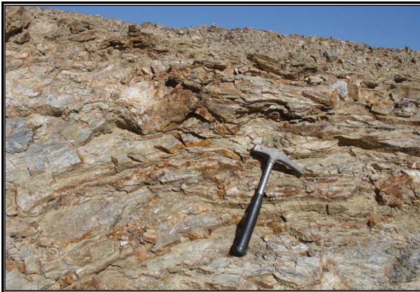
شکل ۳-۲۸- نمائی نزدیک از سنگ دربرگیرنده ماده معدنی در دیواره ترانشه که عبارت از فیلیت حاوی رگه‌های کوارتز است.
