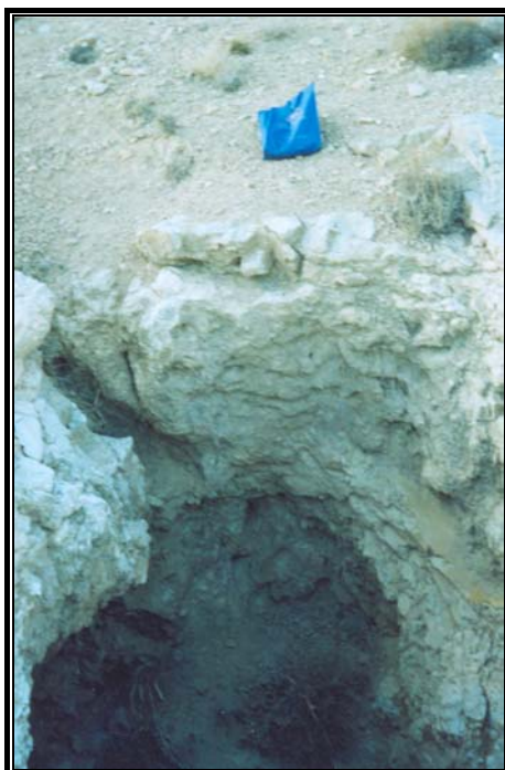
شکل ۳-۹۹- نمائی از چاه قائم به عمق ۱۰ متر در امتداد گسل در معدن متروکه سرب سرمه کوه (دید بسمت خاور).
