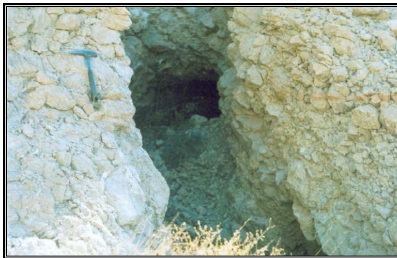
شکل ۳-۹۸- نمای از تونل اصلی معدن سرب سرمه کوه و حالت خرد شده سنگ میزبان (دید بسمت شمال).
