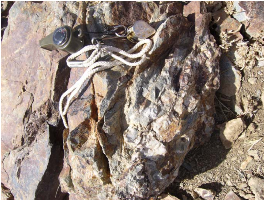
عکس ۳-۴- آهک سیلیسی شده ( نمونه شماره T2-3 )
