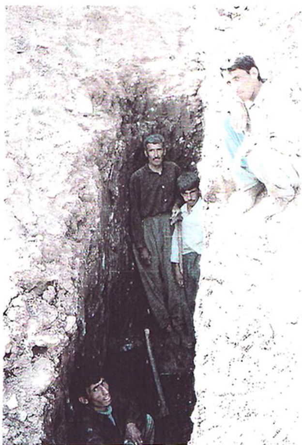
عکس شماره ۱۳ حفر ترانشه بر روی لایه نمک با بیش از عمق ۲ متر. همانطور که در عکس مشخص است پوشیدگی لایه معدنی توسط رسوبات رس و مارن ترانشه زنی را با مشکل مواجه کرده است. (منطقه نختان دید به سمت شمال)
