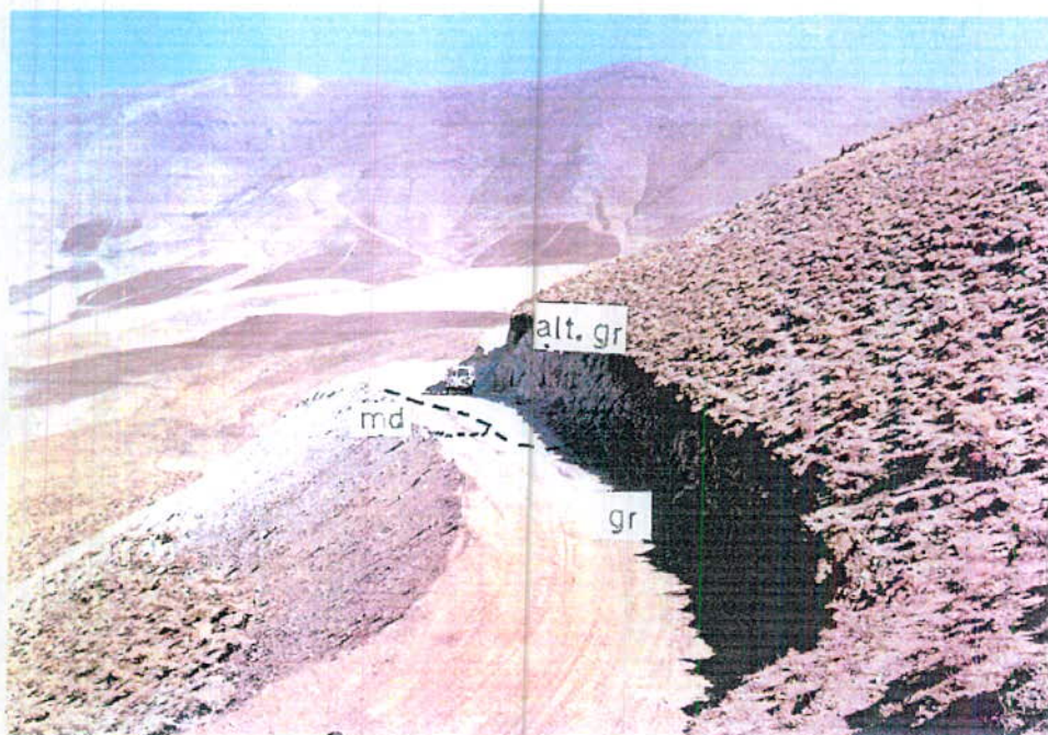
شکل ۱۷-۵- دایک میکرودیوریتی و گسترش آستراسیون آرژیلیک در یک سمت آن (در شاخه شرقی سینه کار شماره ۱ در محل زونهای گوتیتی)
